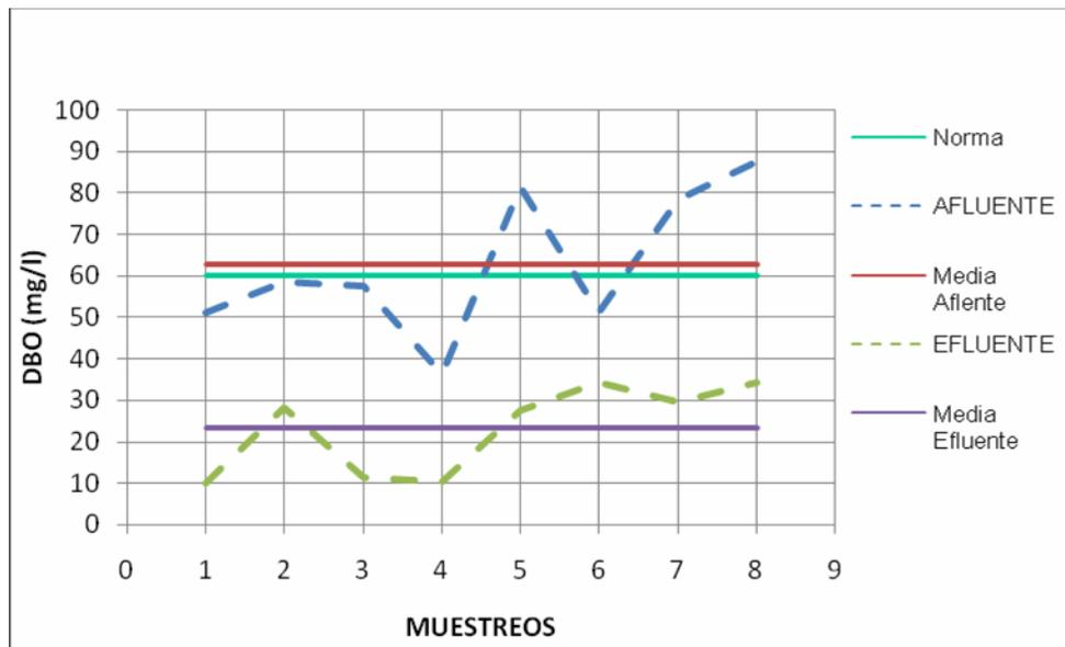
Figura 5.2 Comparación de los valores medio, mínimos y máximos de la  $DBO_5$  con el máximo establecido en la norma venezolana. Fuente propia.
