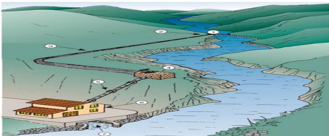
**Figura 2. Central Hidroeléctrica de Aguas Fluyentes**
