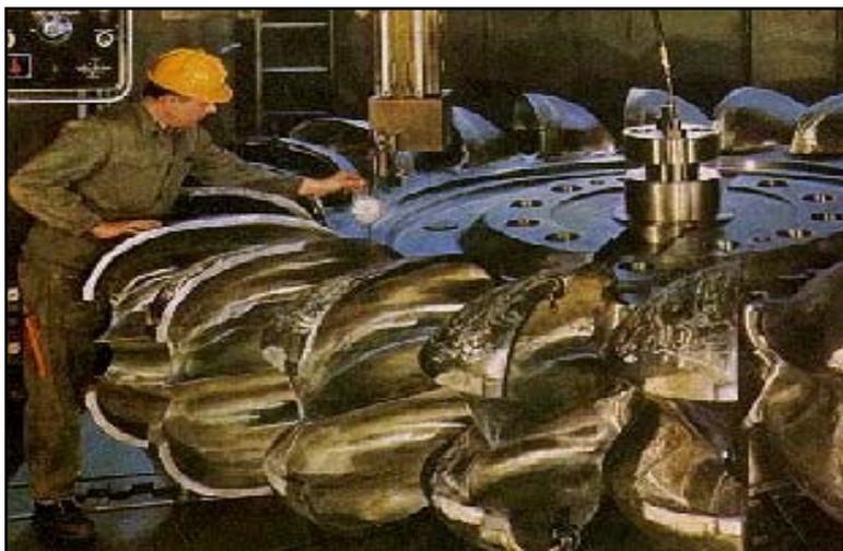
**Figura 13. Turbina Pelton**
