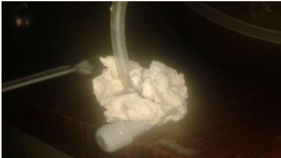
**Figura B.4 Válvula tapada por el efecto del aditivo modificador reológico a base de látex**
