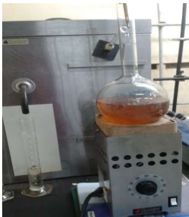
Figura B.2 Destilación atmosférica
