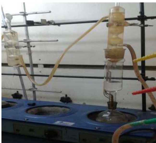
Figura B.3 Recuperación de hexano usando soxhlet
