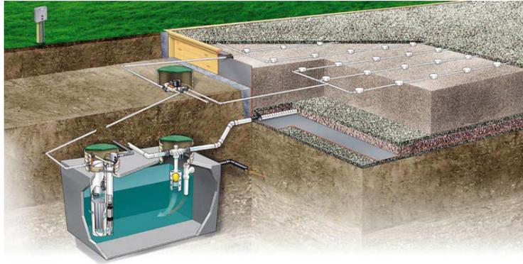
Fig. 9. Sistema de un filtro de arena con recirculación. Fuente: Orenco Systems, Inc. 1998.
