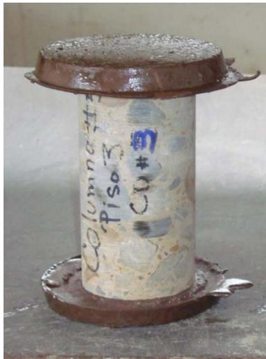
Foto 41. Colocación de capping
