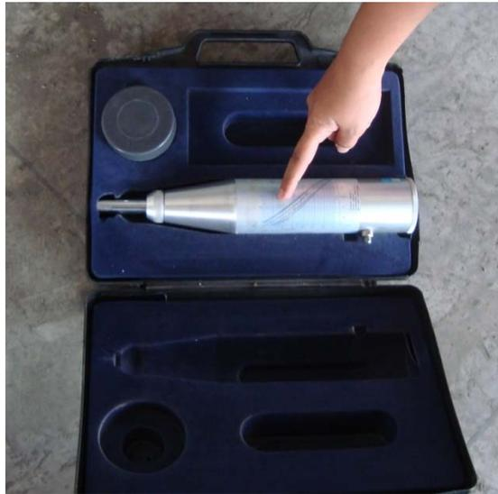
Foto 18. Esclerómetro
