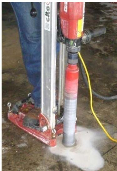
Foto 37. Extracción en losa
