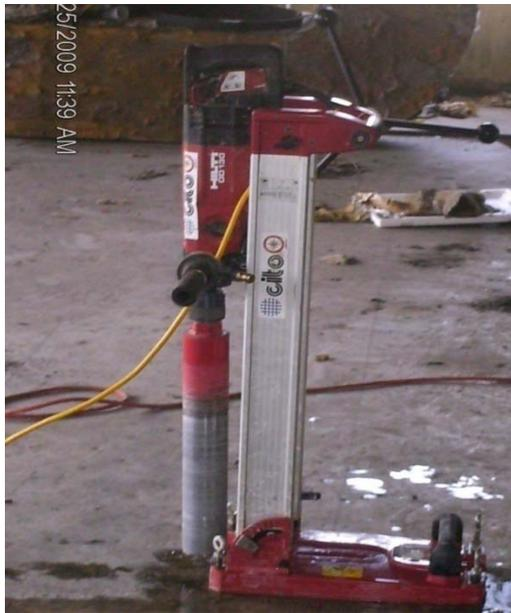
Foto 32. Máquina perforadora de concreto para toma de núcleos.
