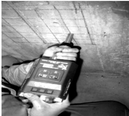
Figura 29. Estimación de la resistencia aproximada del concreto y su uniformidad, mediante el uso de un esclerómetro digital. [5]
