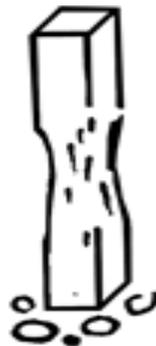
Figura 25. Iniciación de la desagregación de una columna. [22]
