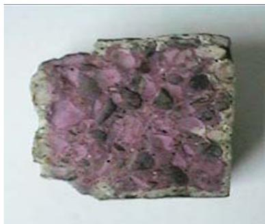
Figura 11. Fotografía que muestra una probeta a la que se le ha aplicado la técnica de la fenolftaleína. [2]
