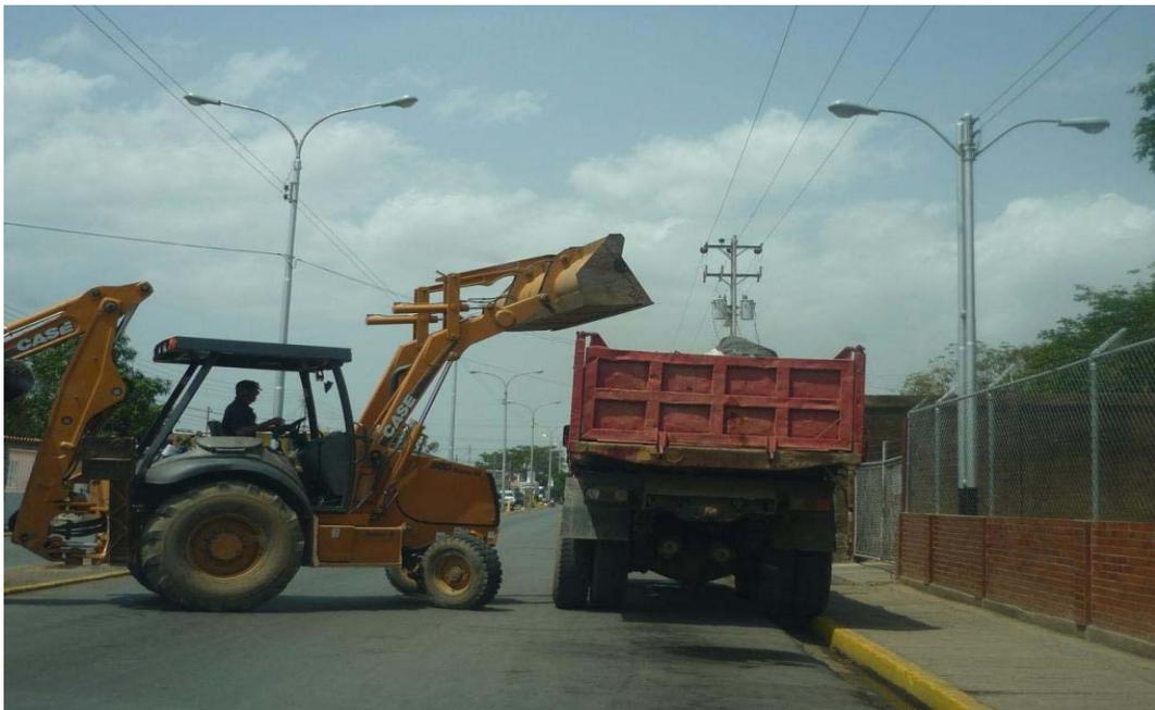
**Figura 4.9** Descarga de la retro en el volteo.
