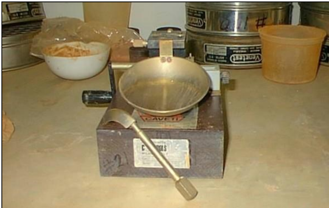
Figura 4.3 Máquina Casagrande utilizada durante el ensayo de límites de consistencia. (Mujica W. y Silveira E., 2011).
