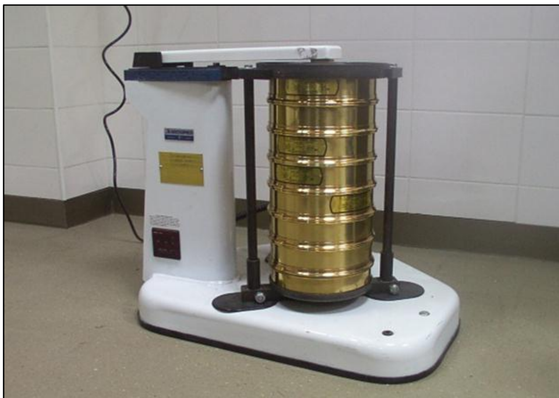
Figura 4.2 Serie de tamices utilizados en el laboratorio para análisis Granulométrico. (Mujica W. y Silveira E., 2011).
