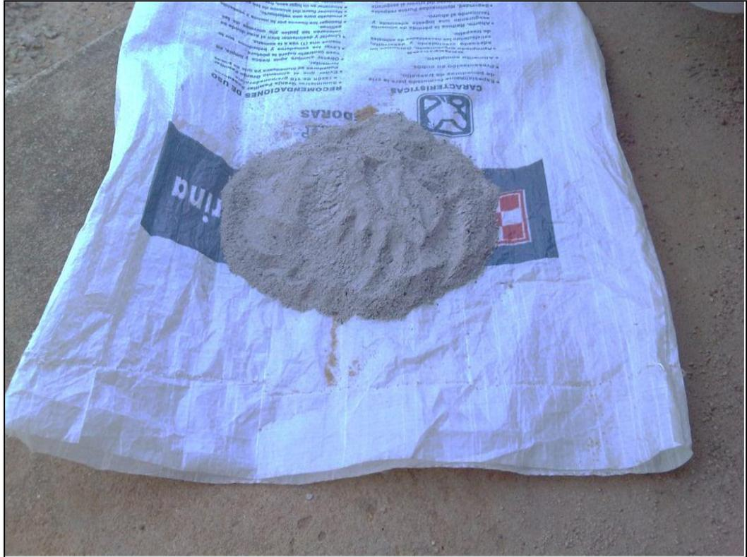
Figura 11. Cantidad de 200 gramos de cenizas para mezcla.
