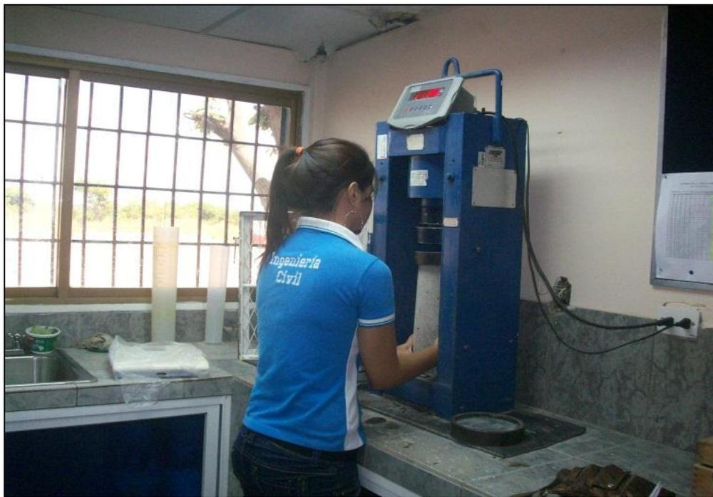
Figura 4.11 Colocación de la probeta en la prensa hidráulica.
