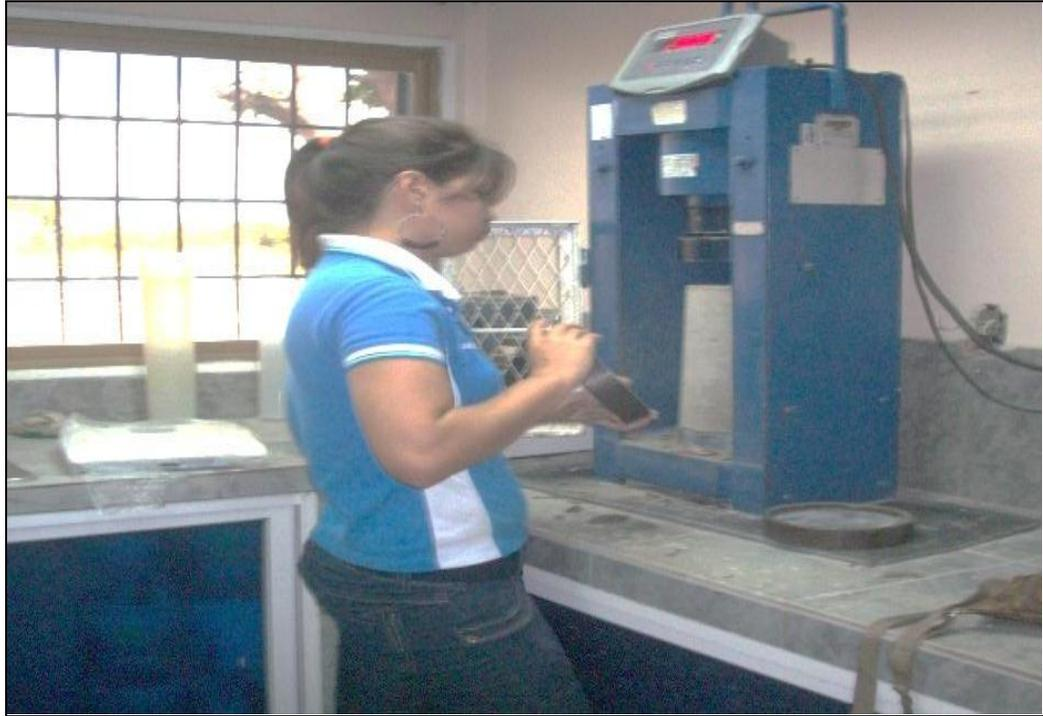
Figura 9. Colocación de probetas en prensa hidráulica.
