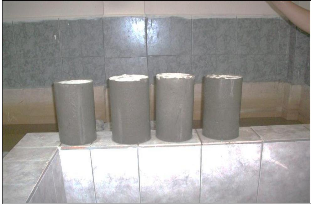
Figura 7. Se extrajeron las probetas de la piscina, para que se secan antes de hacerle la prueba de resistencia.
