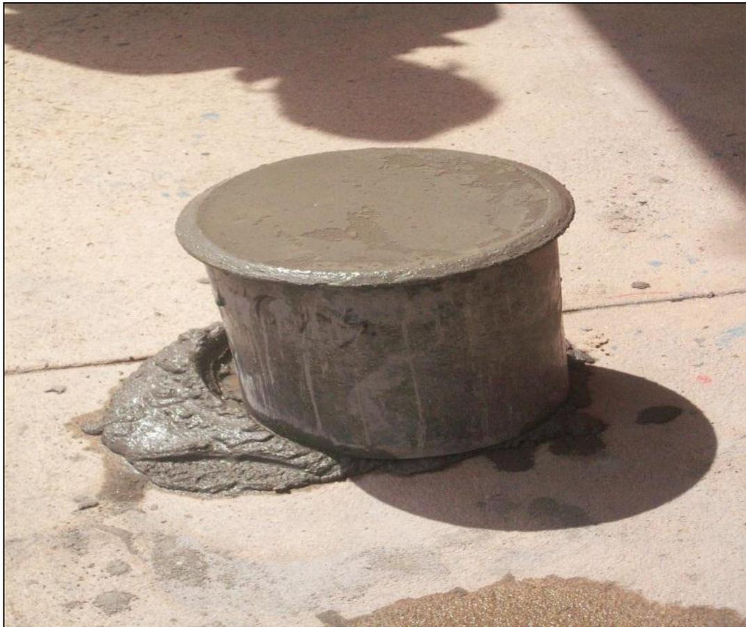
Figura 4.7 Molde con mezcla para ensayo de peso unitario.
