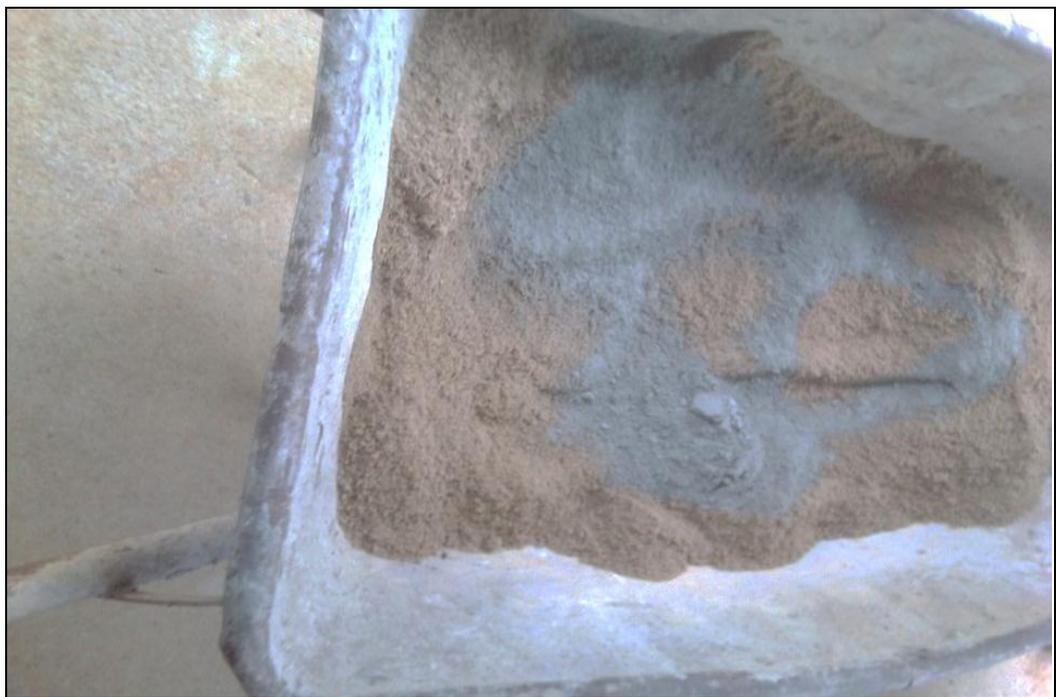
Figura 4. Mezcla de cenizas y arena.
