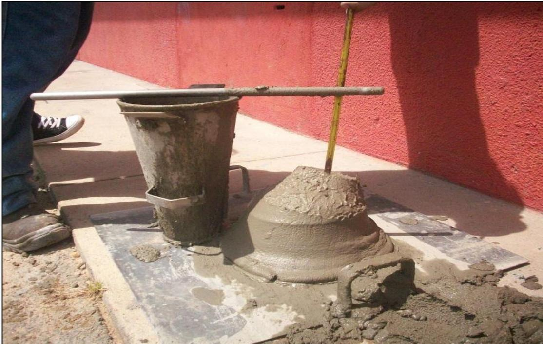
Figura 4.6 Medición de asentamiento.
