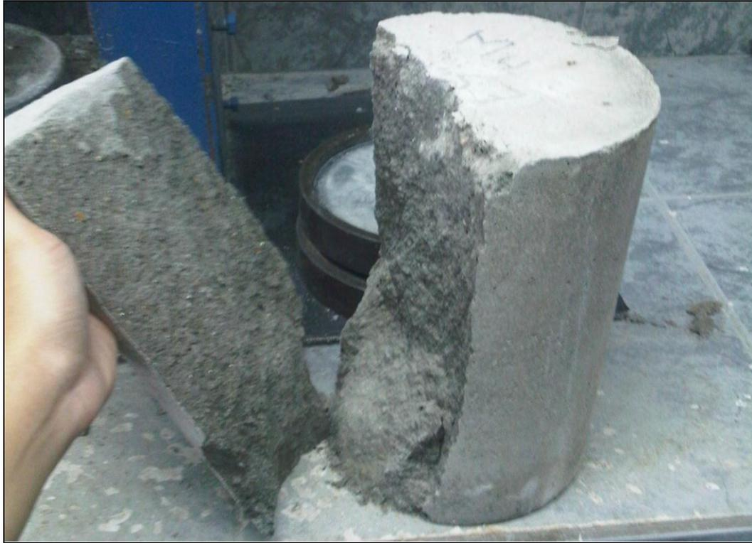
Figura 4.13 Ruptura de la probeta cilíndrica.
