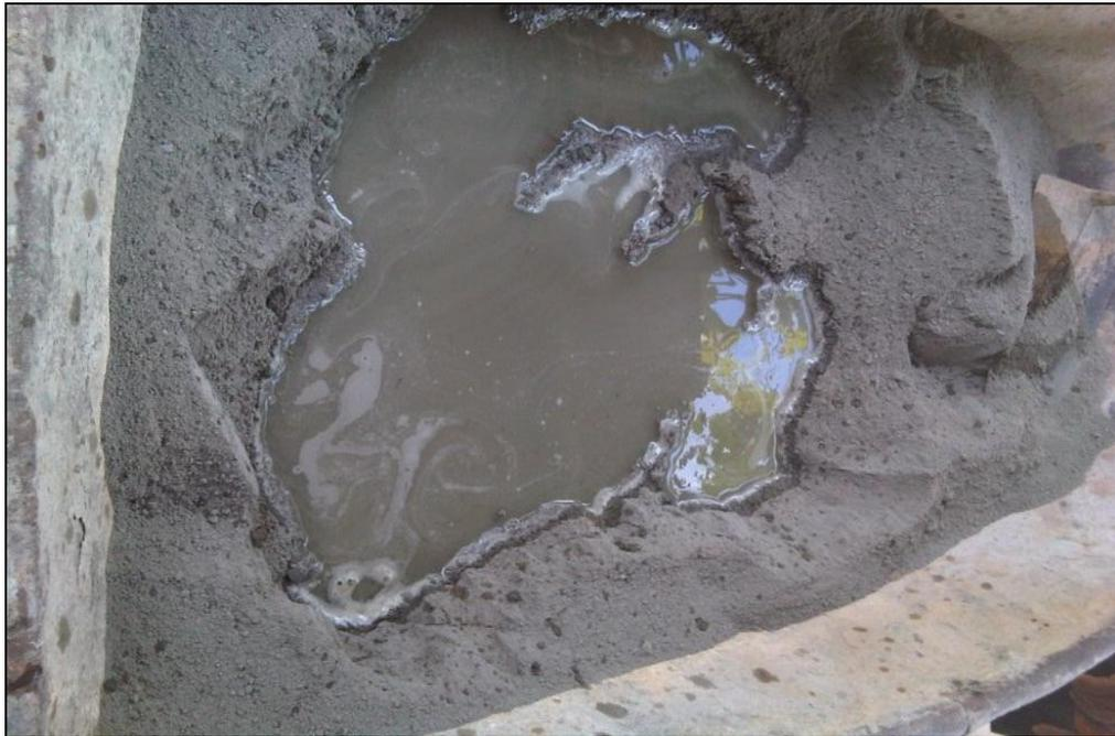
Figura 4.3 Mezcla cemento y mitad de agua requerida.
