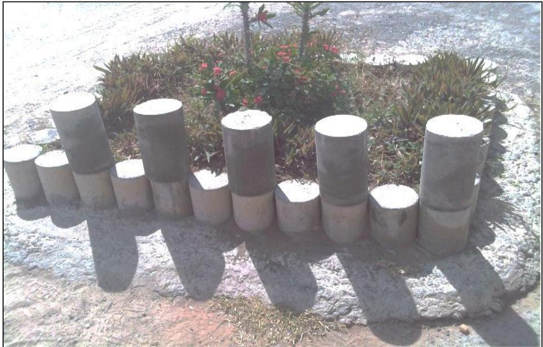
Figura 8. Secado de probetas, para que el curado sea completo.
