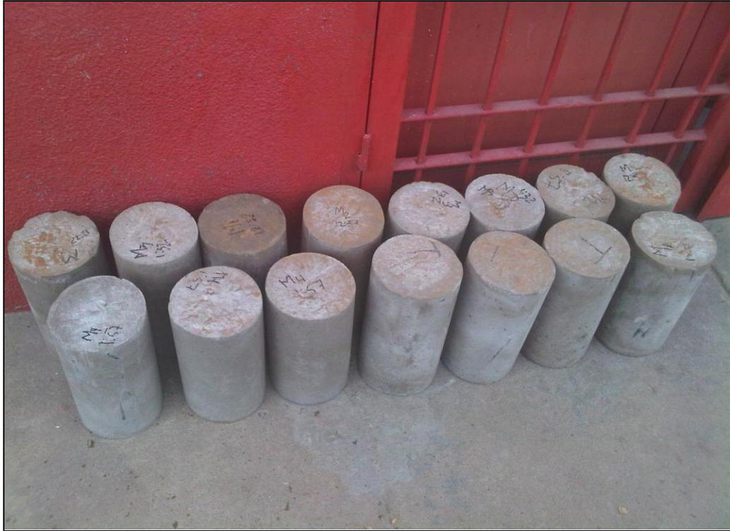
Figura 4.9. Desencofrado de los cilindros.
