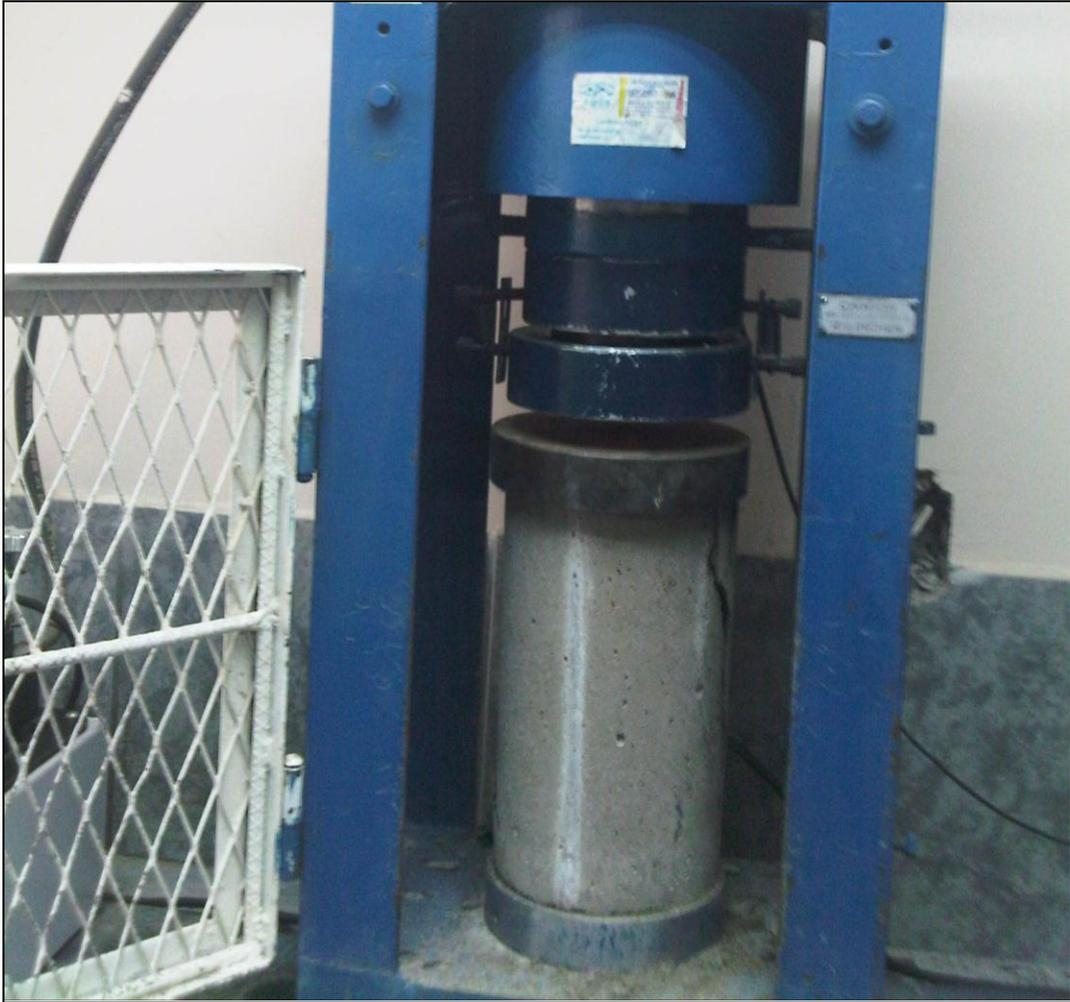
Figura 4.12 Compresión de cilindro en la máquina de ensayo.
