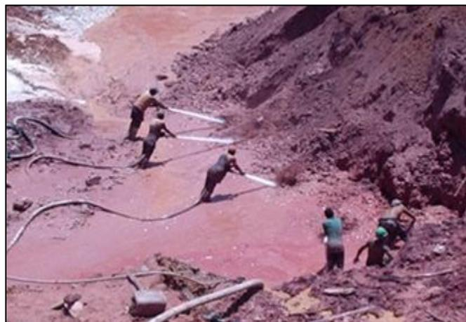
Figura 5.1 Horizontes saprolíticos alterados y muy oxidados, trabajados actualmente con métodos mecanizados
