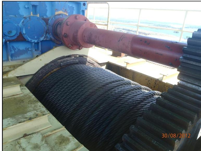
Figura F.5 Tambor de enrollamiento de la guaya “Sistema de Elevación”. (Aponte Anny, 2012).
