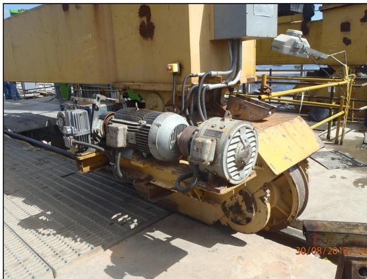
Figura F.4 Sistema de traslación del pórtico de la Grúa. (Aponte Anny, 2012).
