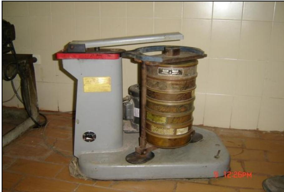
Figura 4.4 Juego de tamices y agitadora empleada para los análisis granulométricos.
