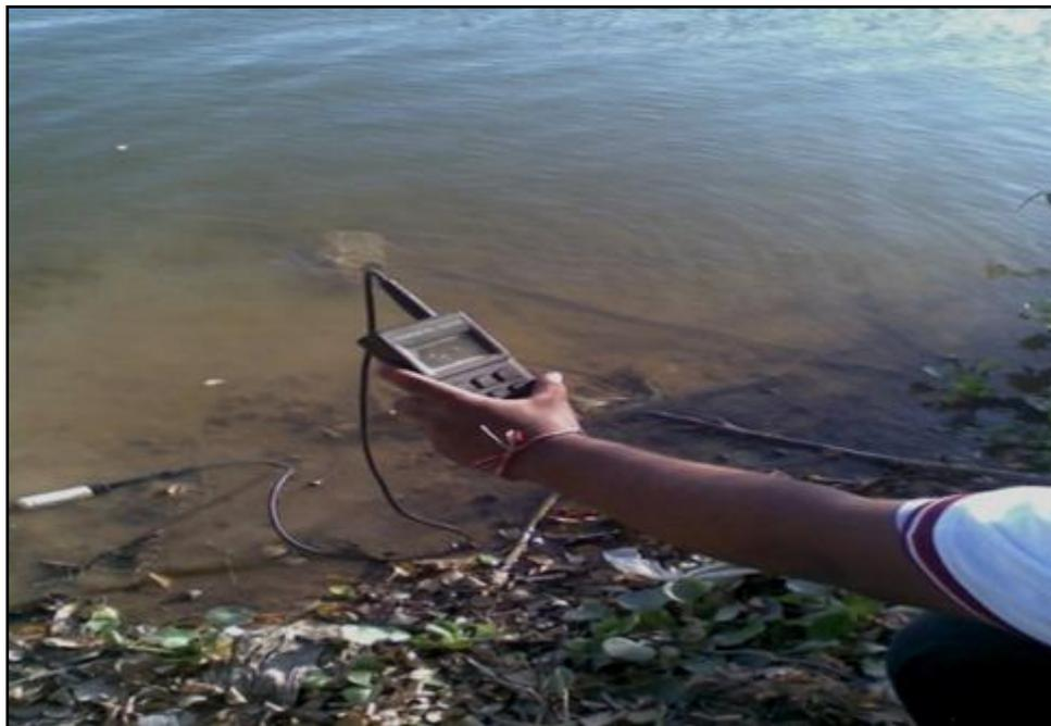
Figura 3.3 Medidor de oxígeno disuelto, marca Hach. Laguna del Medio. (Martin A. y Lara M. 2.001).
