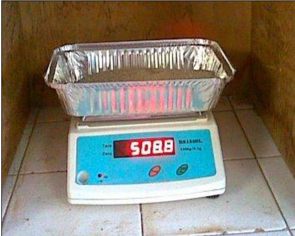
Figura 4.3 Peso de la muestra en la balanza electrónica.
