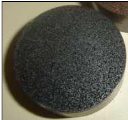
Figura 4.7 Baquelita una vez terminada de pulir.
