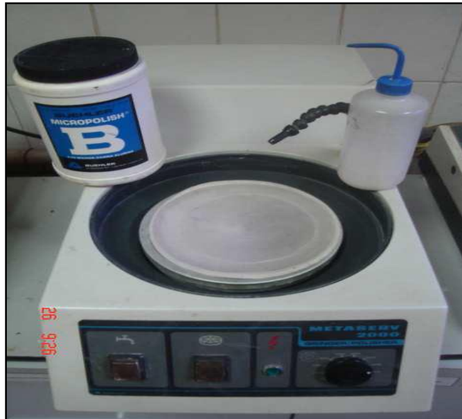
Figura 4.6 Máquina METASERV 2000 desbaste/pulido, con el paño pulidor y alúmina de 0,05 micrón.
