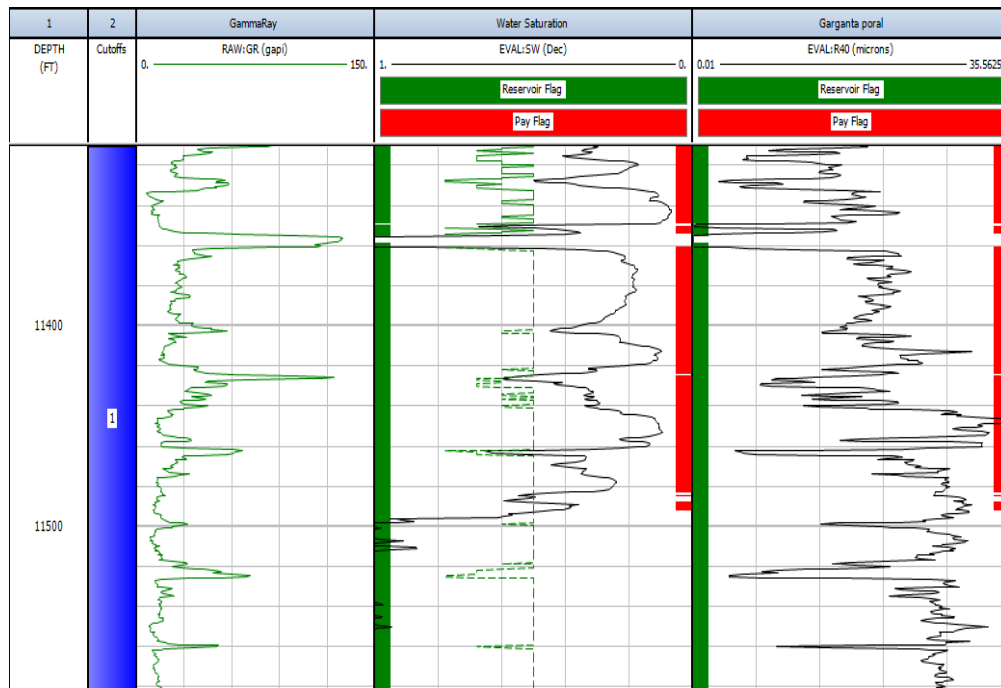
G.13 Gráfico de espesores útiles. Método por Tipos de Roca, Sw máxima. POZO-1.
