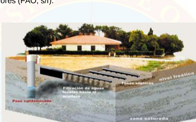
Figura 3. Contaminación de un pozo de extracción de aguas subterráneas por efecto de una fosa séptica
