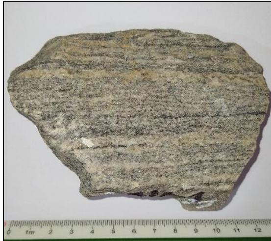
Figura 5.6 Muestra E4-M<sub>1</sub>. Gneis biotítico.
