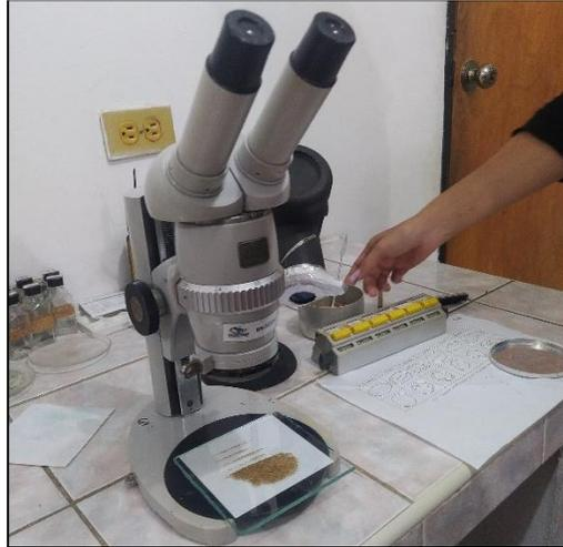
Figura 4.5 Microscopio estereográfico con muestra de sedimento en el portaobjeto.
