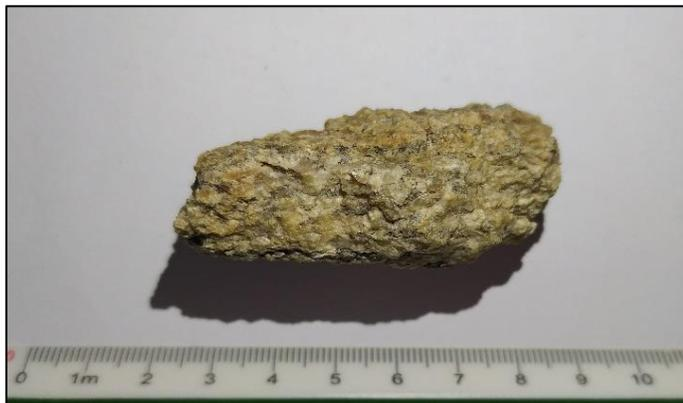
Figura 5.3. Muestra E<sub>1</sub>-M<sub>3</sub>. Gneis biotítico cuarzoso.
