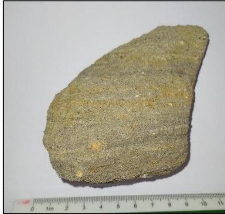
Figura 5.9 Muestra E<sub>4</sub>-M<sub>3</sub>. Arenisca limosa.
