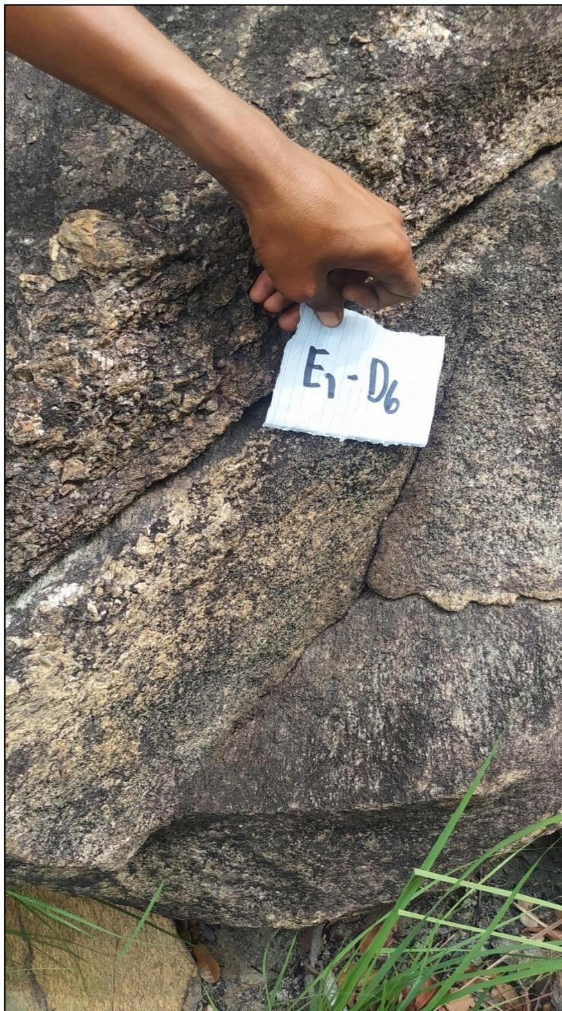
Figura 5.14. Diaclasa inclinada  $E_1-D_6$ , de 2 cm de abertura.
