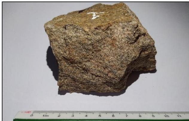
Figura 5.1 Muestra E<sub>1</sub>-M<sub>1</sub>. Gneis feldespático biotítico.
