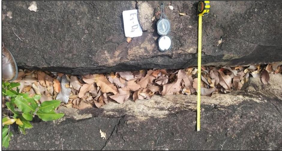
Figura 5.15. Diaclasa vertical E<sub>1</sub>-D<sub>7</sub>, de 30 cm de abertura.
