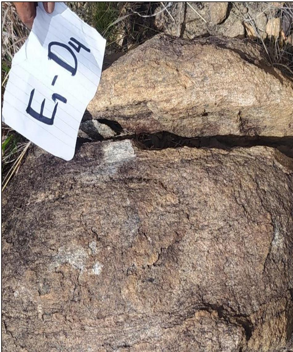
Figura 5.13 Diaclasa inclinada  $E_1-D_4$ , de 2cm de abertura.
