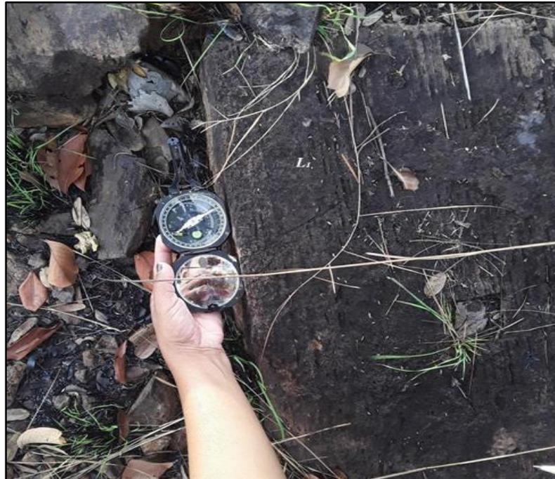
Figura 5.13 Medición de la foliación en un afloramiento dentro del área de estudio.
