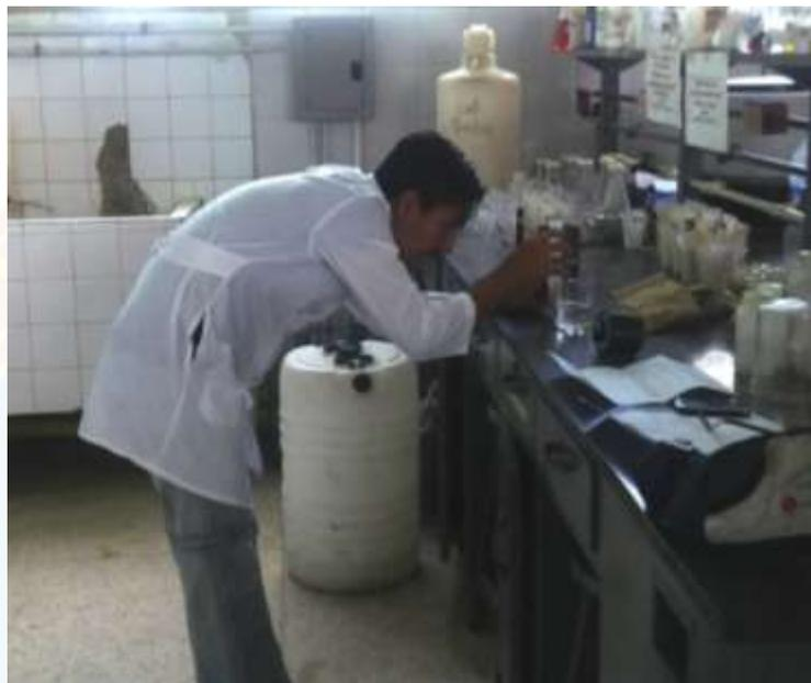
**Figura 4. Agregado de la Solucion de  $\text{NH}_4\text{F}$  y  $\text{HCl}$  1N**
