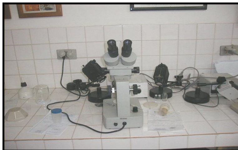
Figura 5.7 Equipo utilizado para la descripción de los minerales pesados presentes en las muestras recolectadas en campo.
