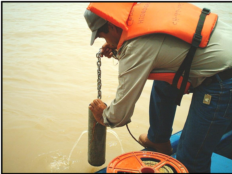
Figura 5.6 Toma de muestras de fondo en el río Orinoco.
