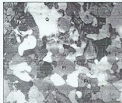
Muestra M3 A2 (NX) 10X/10X: se observan cristales xenoblásticos mayormente de tamaño fino a medio de feldespato (Fk), cuarzo (Q) y plagioclasa (Pi) formando un mosaico granoblástico de contactos lobulados.
