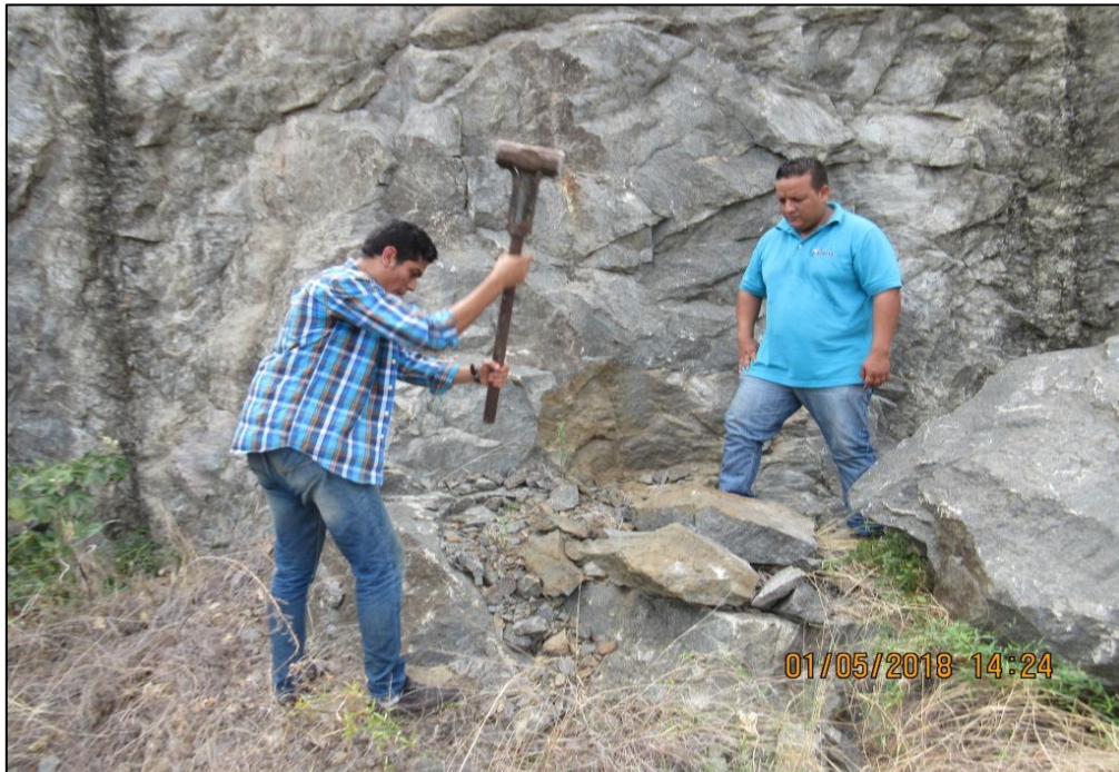
Figura 4.4 Instrumento utilizado para la recolección de muestras en la zona de explotación del cerro.
