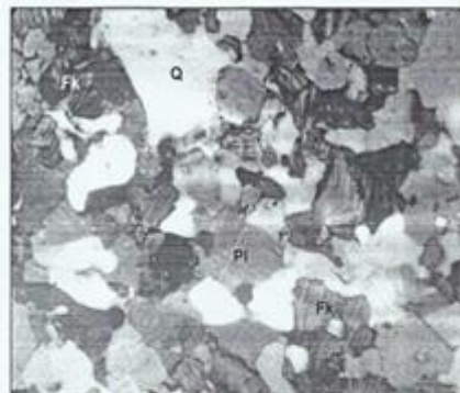
Muestra M1 A1 (NX) 10X/10X: se observan cristales xenoblásticos mayormente de tamaño fino a medio de feldespatos (Fk), cuarzo (Q) y plagioclasa (Pl), formando un mosaico granoblástico de contactos lobulados.
