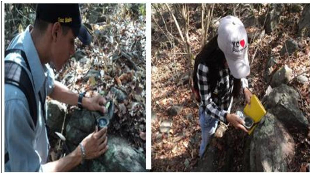
Figura 4.3 Medicion de los buzamientos de las diaclasas en los gneises muy meteorizados.
