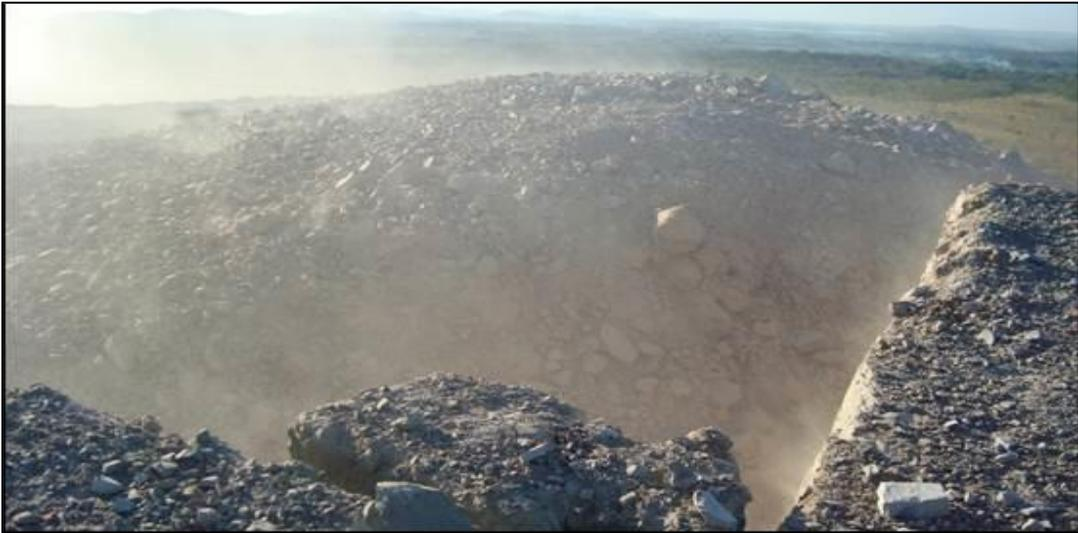
Figura 3.2 Roca fragmentada, producto de voladura en la cantera La Tortilla, Sistema Vial Tercer Puente sobre el Rio Orinoco.
