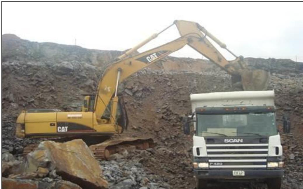
Figura 5.3 Carga de camión Scania P420 con excavadora Caterpillar.
