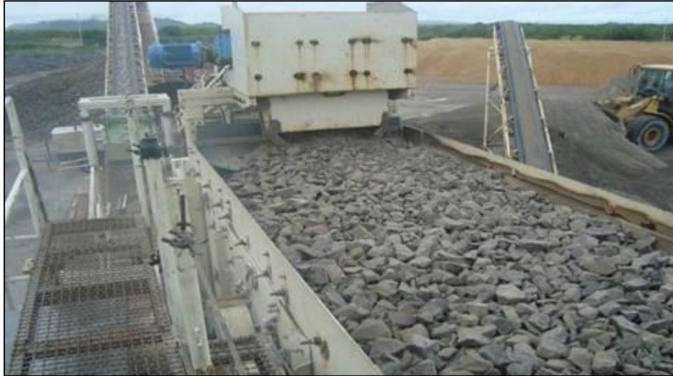
Figura 5.6 Cribado de material.
