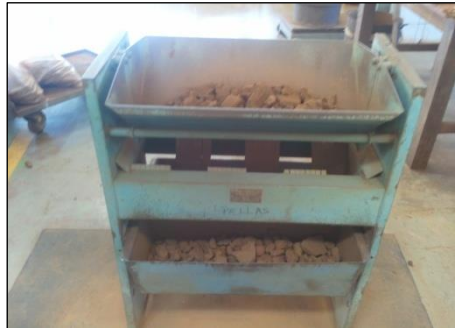
Figura 4.4 Muestra en proceso de homogeneización.
