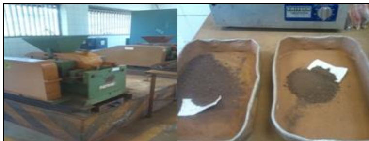
Figura 4.6 Molino de rodillos (izq.). Muestras molidas (der.).
