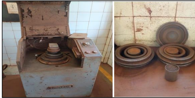
Figura 4.7 Pulverizadora de anillos (izq.). Anillos de pulverizado (der.).
