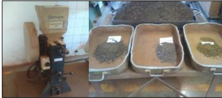
Figura 4.5 Trituradora de mandíbula (izq.). Muestras trituradas (der.).
