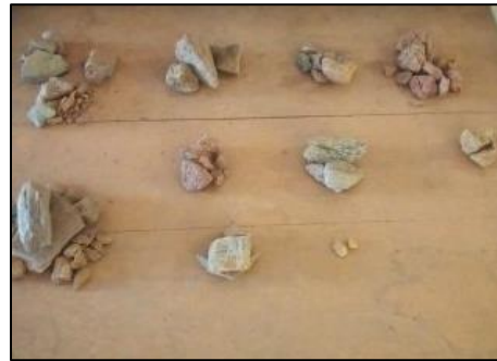
Figura 4.11 Clasificación en grupos litológicos de la muestra GSIC2030.
