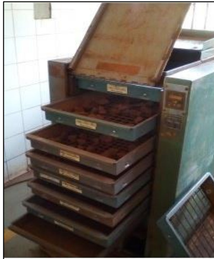
Figura 4.9 Tamizadora con muestra cargada.
