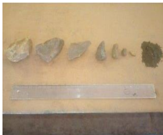
Figura 5.1 Distribución del tamaño del mineral de hierro desde la malla 1 3/4" a PAN (izq. a der.).
