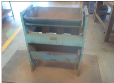
Figura 4.3 Cuarteador de mineral de hierro grueso.
