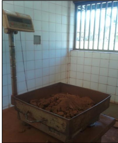
Figura 4.10 Pesaje del mineral retenido en cada tamiz.
