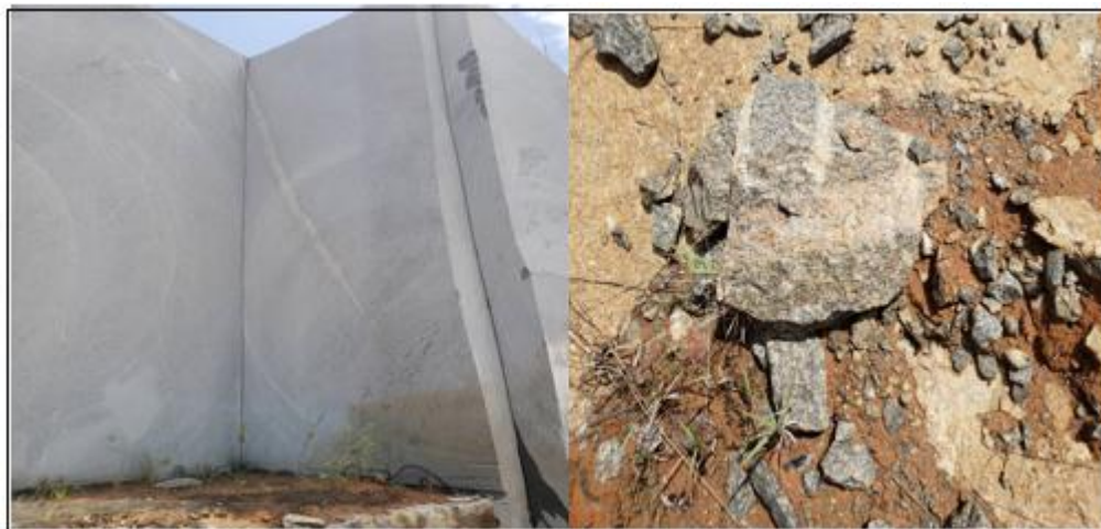
Figura 5.2 Roca fresca (lado izquierdo) y la foto de la derecha es la pátina de meteorización de la misma roca.
