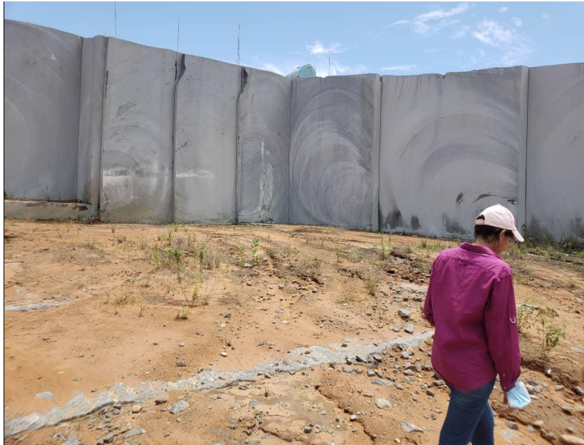
Figura 5.5 Frentes de explotación cortado con hilo adiamantado.
