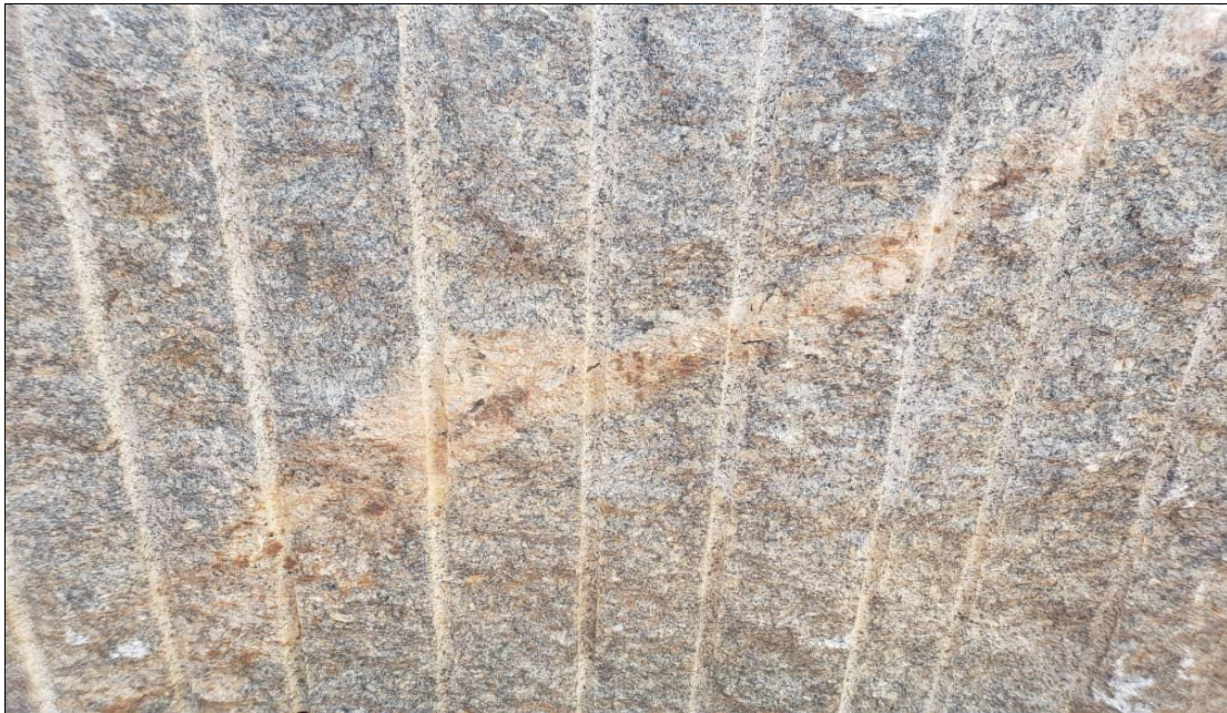
Figura 5.7 Veta emplazada en una fractura, la cual le quita valor comercial al bloque.
