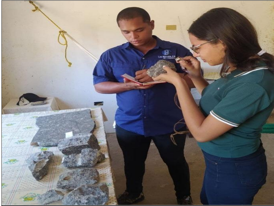
Figura 5.3 Descripción macroscópica de cada muestra de roca, para compararla con la lámina pulida.
