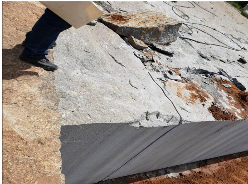
Figura 5.6 Pátina color naranja, producto de la descomposición de los minerales.
