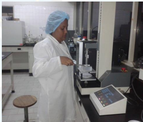
Figura 5. Prueba de resistencia al corte a los jamones de macabí ( Albula vulpes L).
