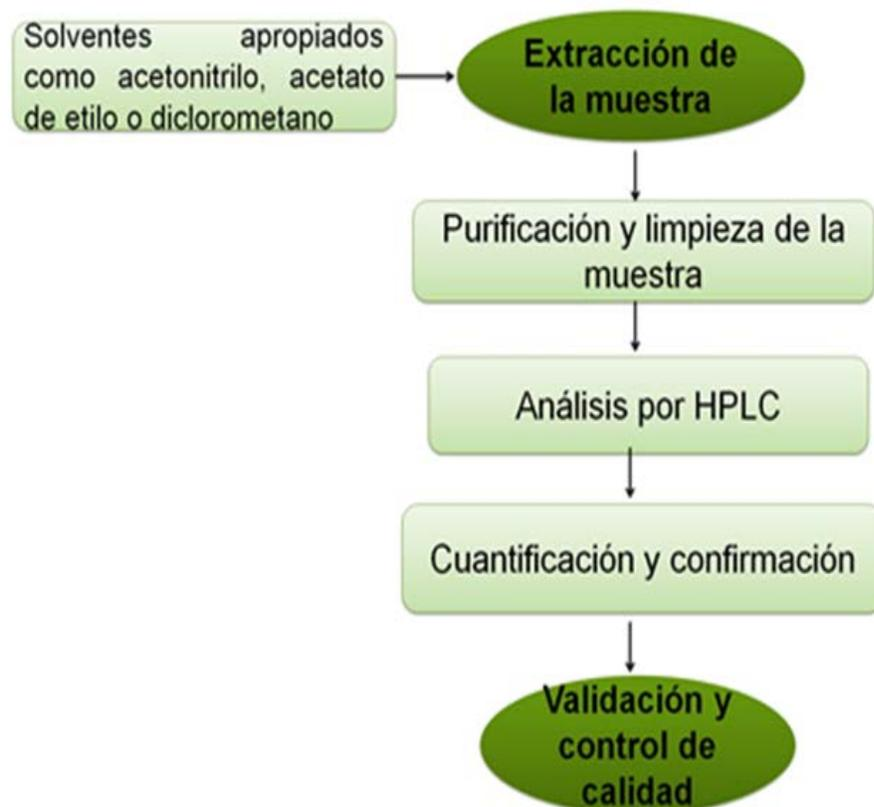
**Figura 7. Diagrama de flujo para la detección y cuantificación de los residuos provenientes de antibióticos y desparasitantes mediante cromatografía líquida de alta resolución (HPLC)**
