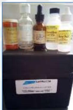
**Figura 8. Test marca Lamotte para oxígeno disuelto**
