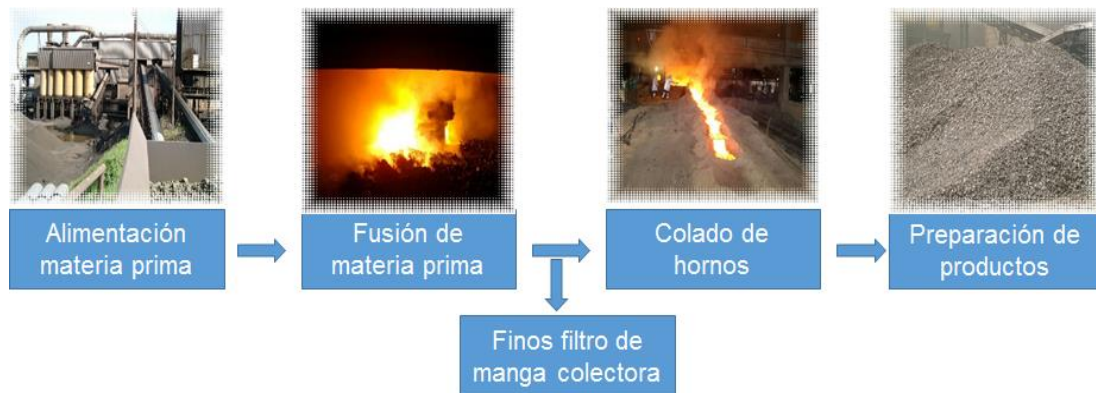
Figura 4. Esquema del proceso productivo de HEVENSA [26].
