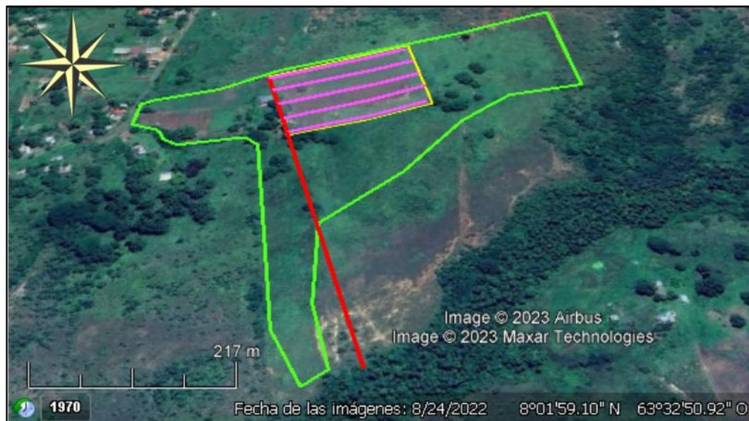
Figura 5.4 Trazado en planta de los canales secundarios o laterales (líneas lila) y el colector principal (línea roja).
