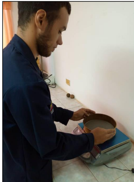
Figura 4.9 Pesando el tamiz con la muestra retenida.
