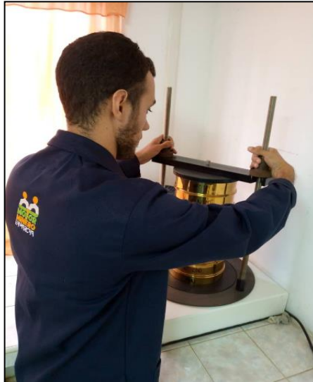
Figura 4.8. Tamizando la muestra.
