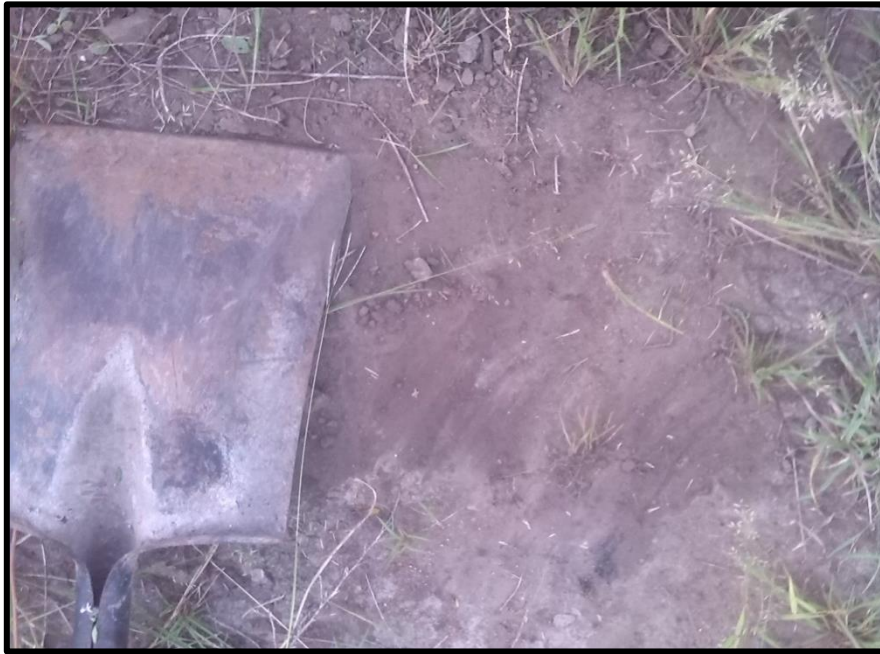
Figura 4.5 remoción de la capa vegetal para la extracción de una muestra de suelos.
