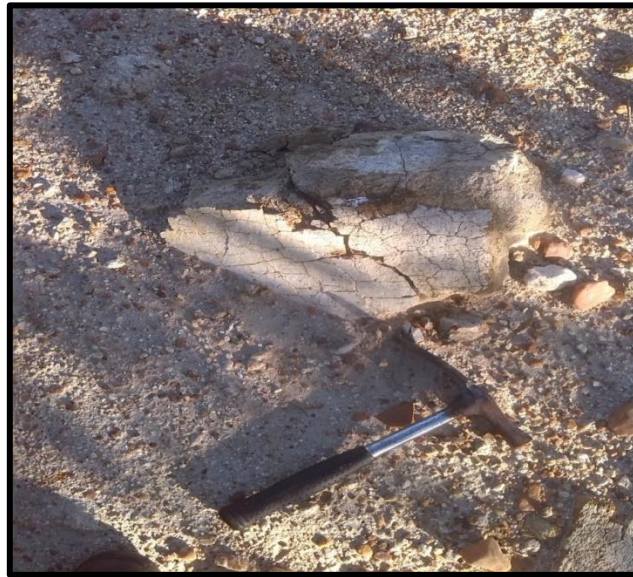
Figura 5.3 Suelos y fragmentos de rocas descompuestos in situ.
