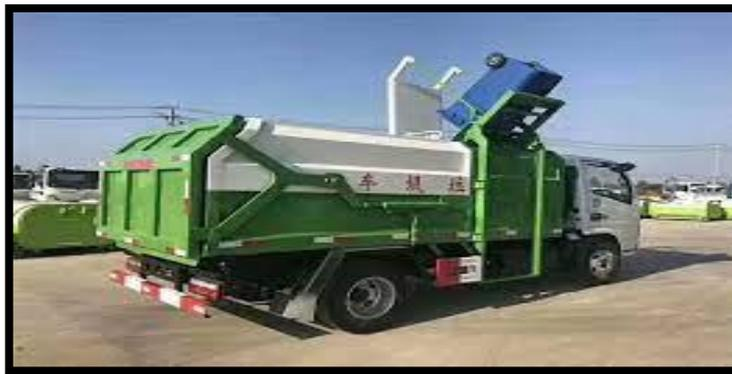
Figura 5.17. Camión recolector de carga lateral
