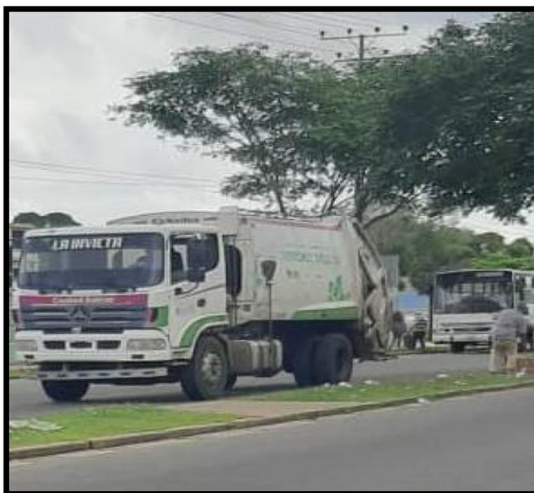
Figura 5.1 Camión compactador de basura del sector Agua Salada.
