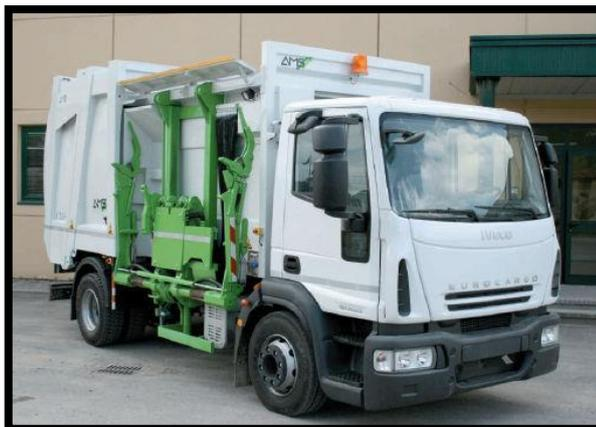
Figura 6.6. Camión de carga lateral.
