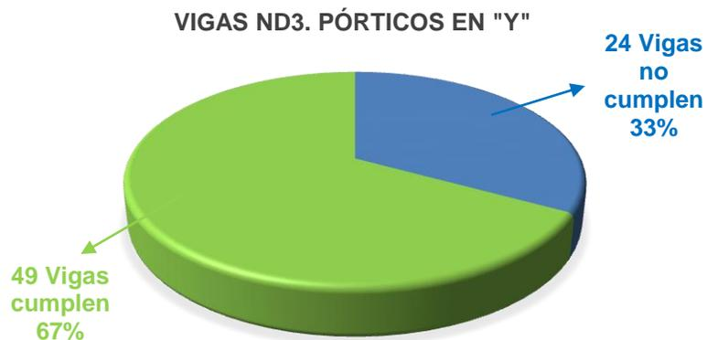
Figura N°41. Gráfico de vigas en ND3. Pórticos en "Y". Fuente: Autores.
