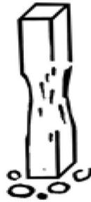
**Figura N°17. Iniciación de la desagregación de una columna. Fuente: Serrano, J y Silva, E (2010).**
