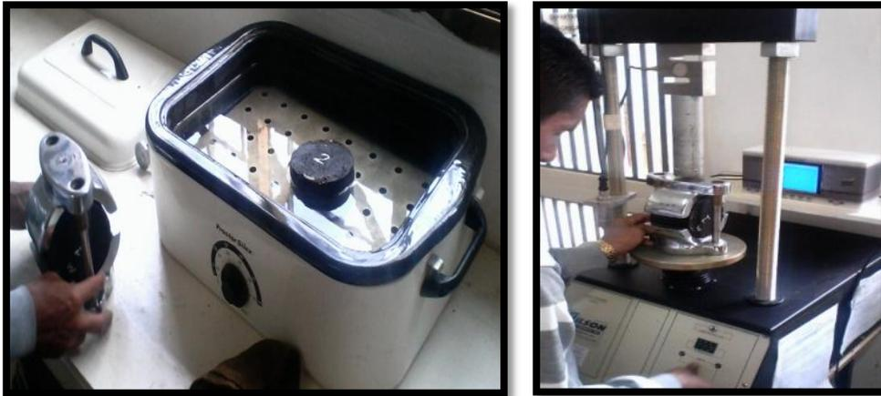
Figura N° 4.7 Estabilidad y fluencia Marshall.
