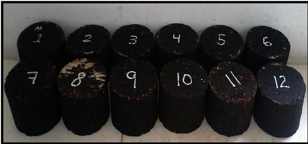
Figura N° 4.6 Briquetas compactadas.
