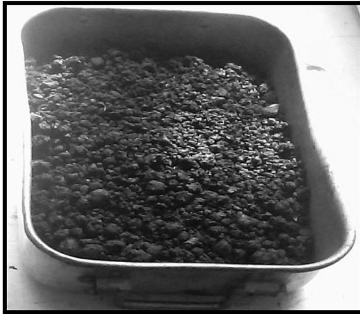
Figura N° 4.5 asfalto frío pre mezclado.
