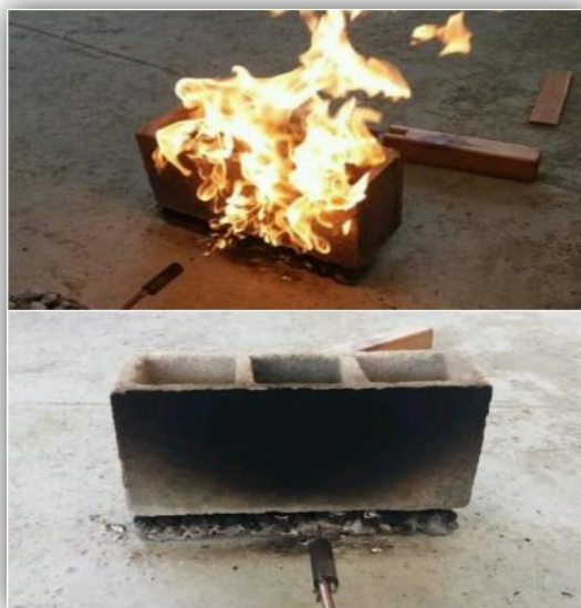
Figura 22. Prueba de resistencia al fuego bloque BH-C
