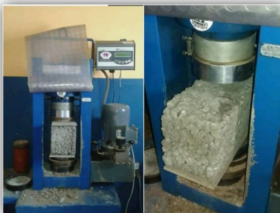
Figura 16. Prueba de resistencia a la compresión de los bloques propuestos Fuente: Autores
