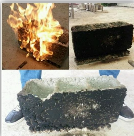
Figura 21. Prueba de resistencia al fuego bloque BH-AC Fuente: Autores
