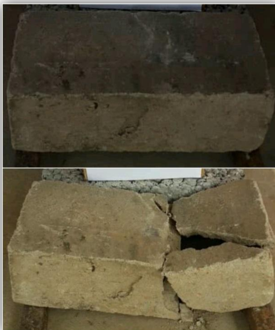
Figura 19. Resistencia al impacto del bloque BH-C Fuente: Autores
