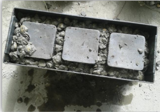
Figura 10. Proceso de moldeado de la mezcla en formaleta manual Fuente: Autores
