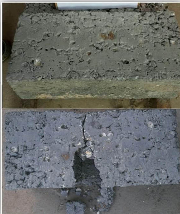
Figura 18. Resistencia al impacto del bloque BH-AC Fuente: Autores
