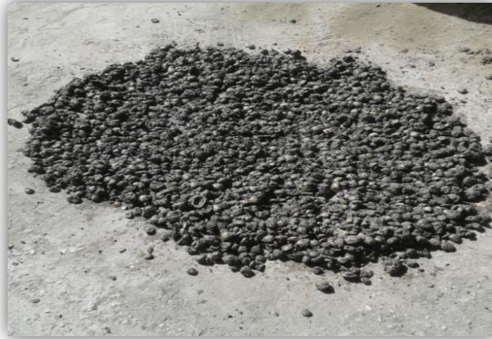
Figura 7. Mezclado de las conchas de moluscos con agua y cemento Fuente: Autores.
