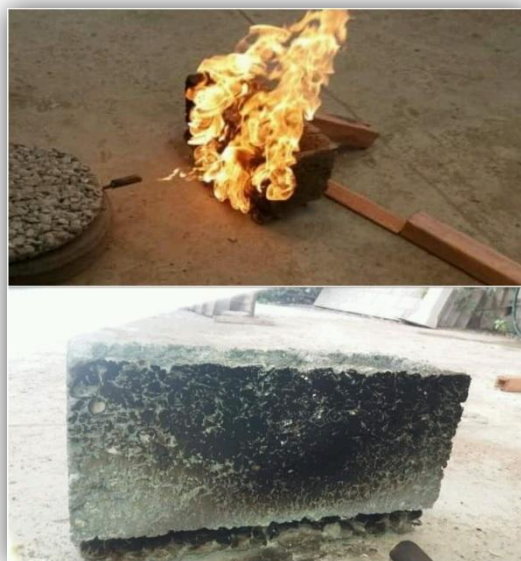
Figura 20. Prueba de resistencia al fuego bloque BH-CC
