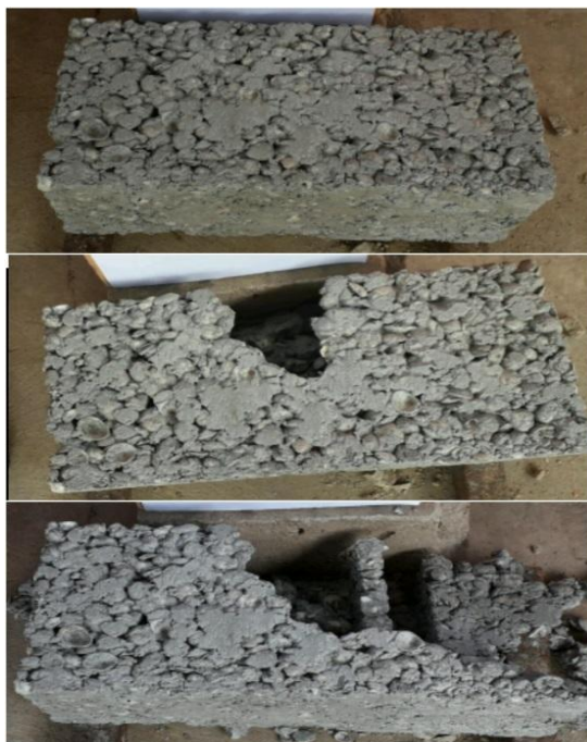
Figura 17. Resistencia al impacto del bloque BH-CC Fuente: Autores
