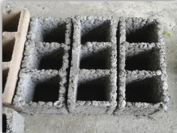
Figura 13. Bloques curados y secados Fuente: Autores
