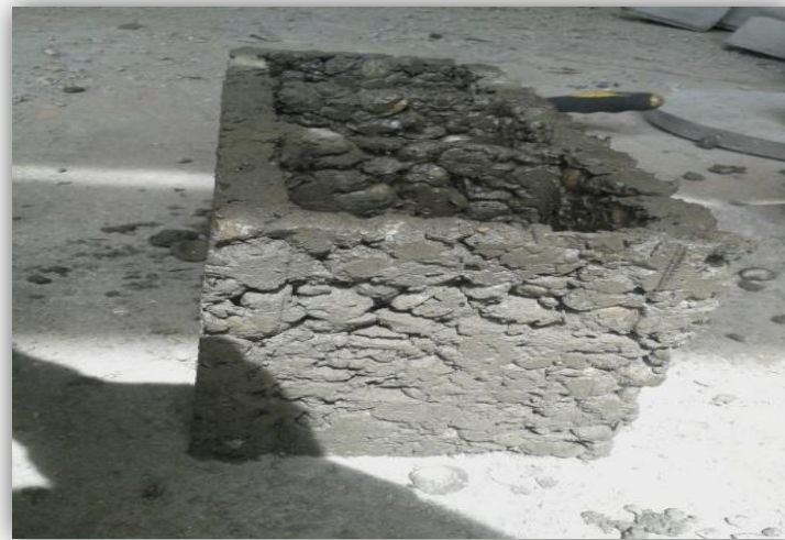
Figura 8. Bloque de mezcla con conchas de moluscos agua y cemento Fuente: Autores
