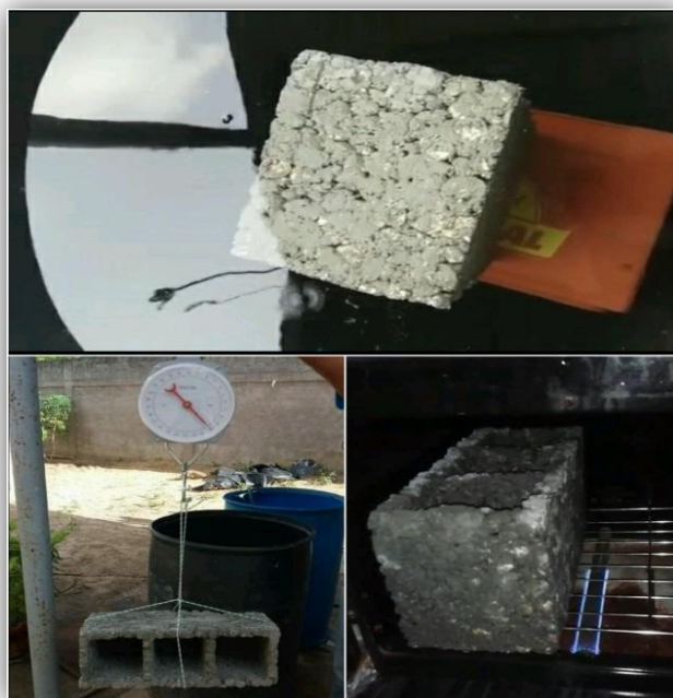
Figura 15. Ensayo absorción de agua. Fuente: Autores.
