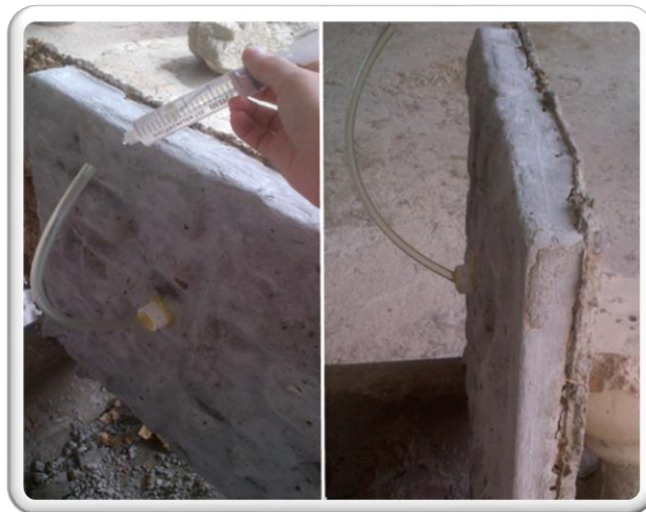
Figura 20. Ensayo de impermeabilidad para panel con revestimiento
