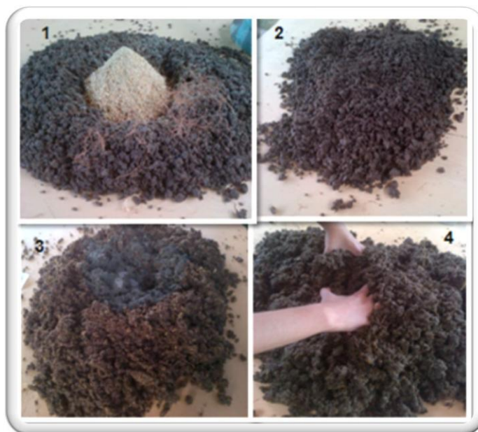
Figura 11. Preparación de la mezcla para los paneles
