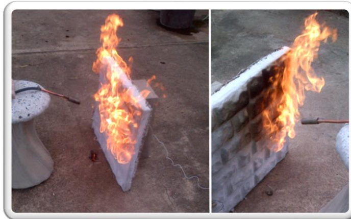
Figura 18. Ensayo de resistencia al fuego de paneles con revestimiento
