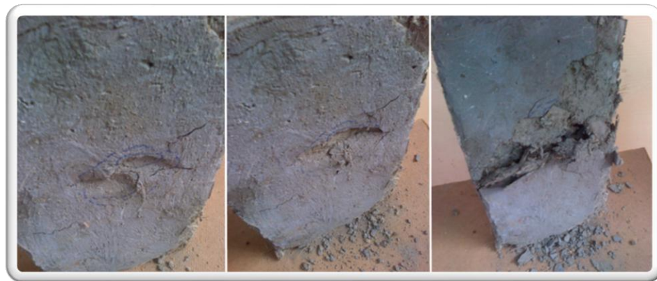
Figura 22. Resistencia al impacto de panel con revestimiento de 10mm
