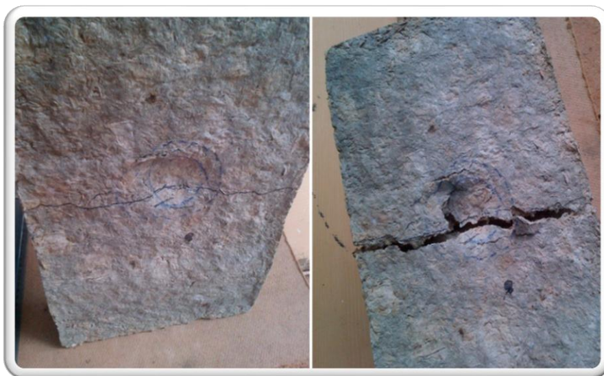
Figura 21. Ensayo de resistencia al impacto de paneles sin revestimiento
