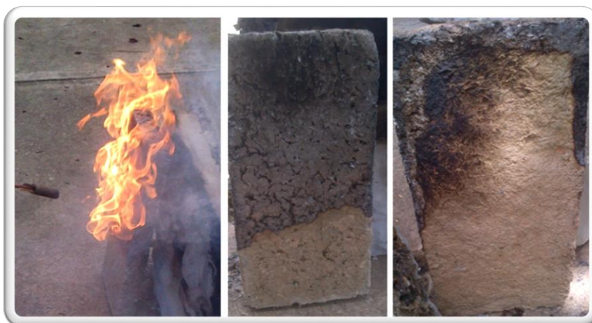
Figura 17. Prueba de resistencia al fuego a paneles sin revestimiento
