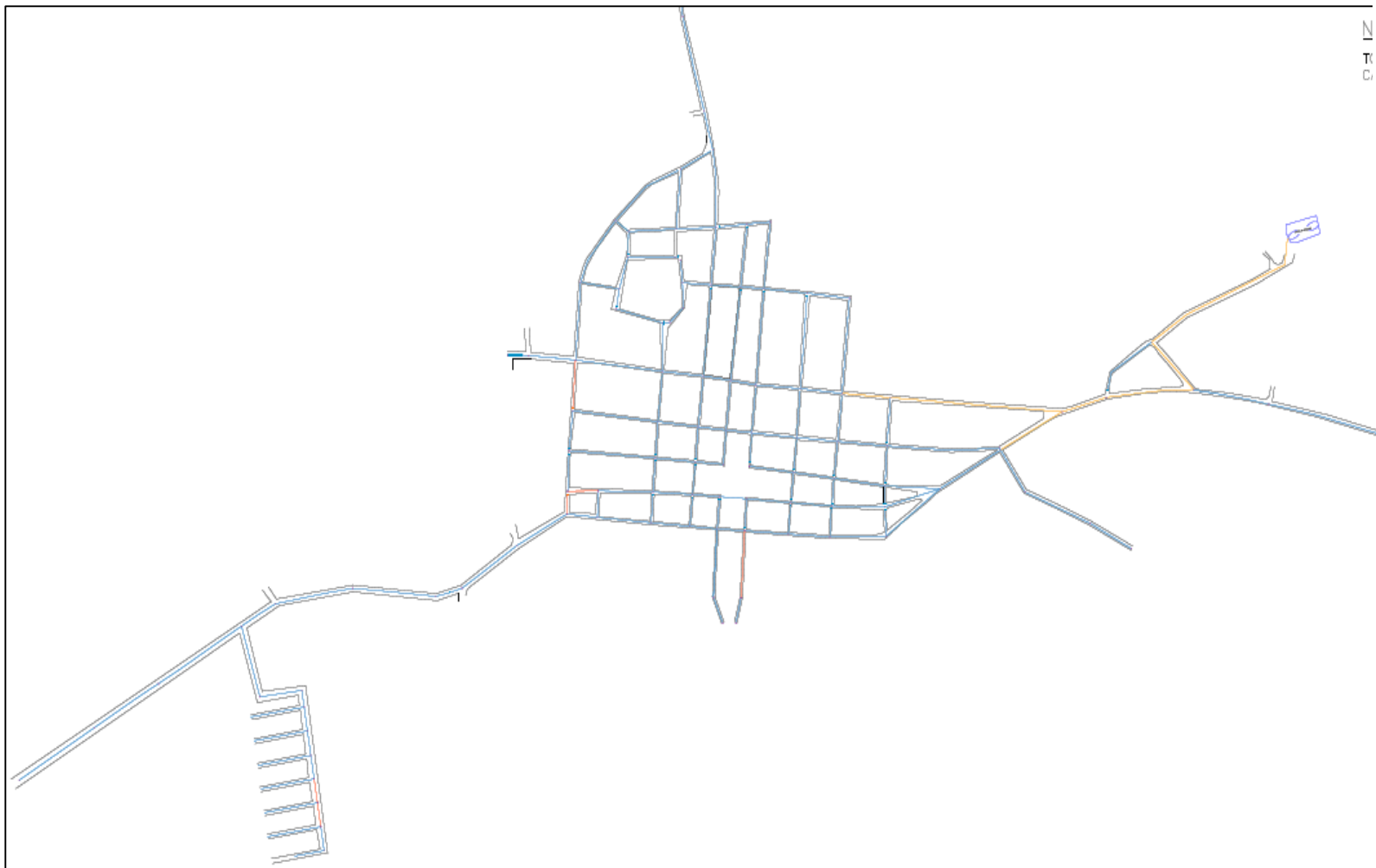
Figura 26. Representación gráfica de los tramos que colapsan y fallan por velocidad. Fuente: Autores.
