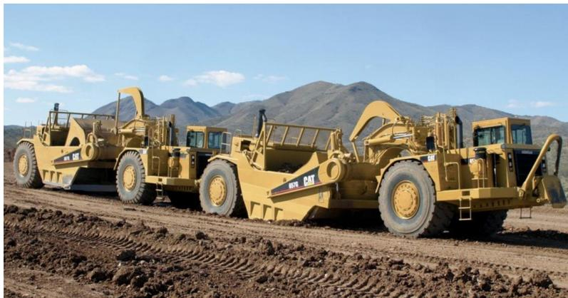
**Figura 10. Maquinaria para movimiento de tierra.**
