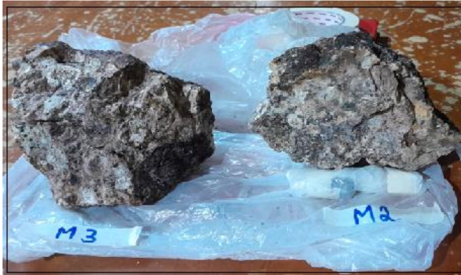
Figura 5.4 Muestras M2 y M3 de granito de Parguaza. Notese la forma ovoide de los Feldespato, típica de la textura rapakivi.
