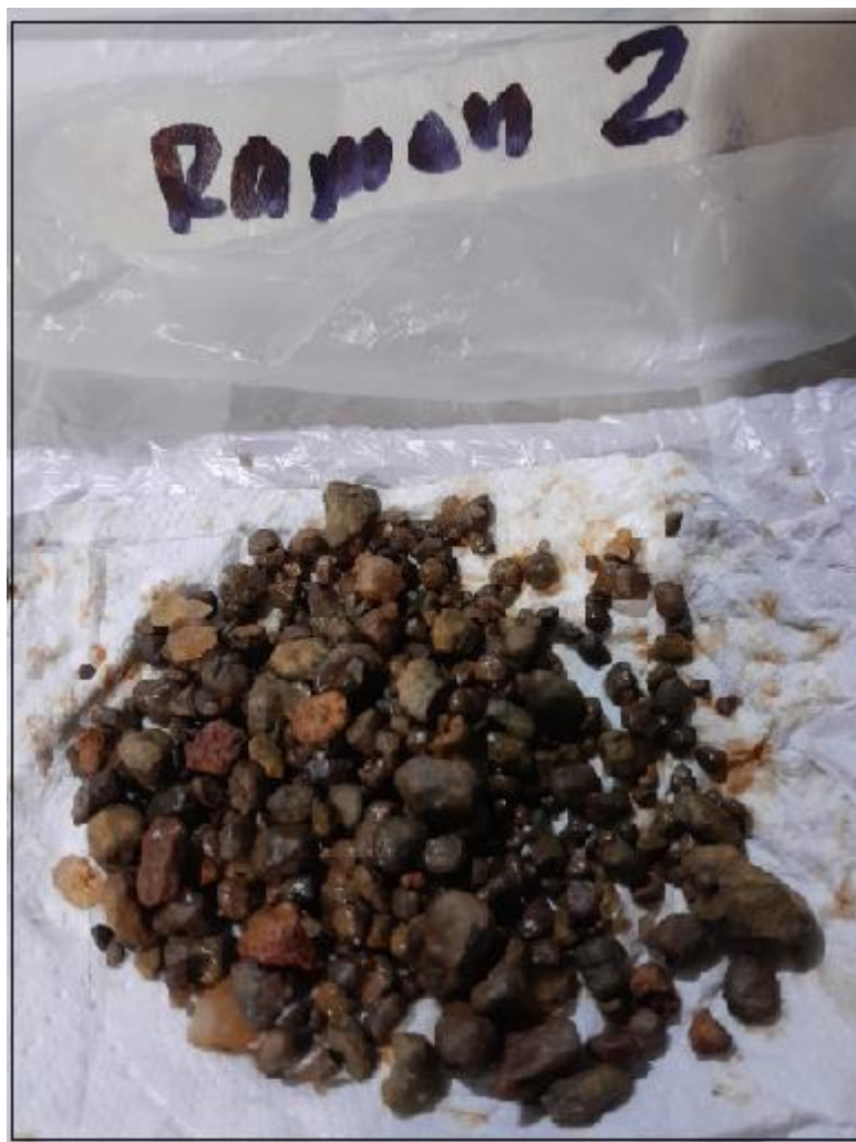
Figura 5.11 Muestra donde se observan granos subredondeados de Tantalio, Ilmenita, fragmentos de cuarzo y de rocas.
