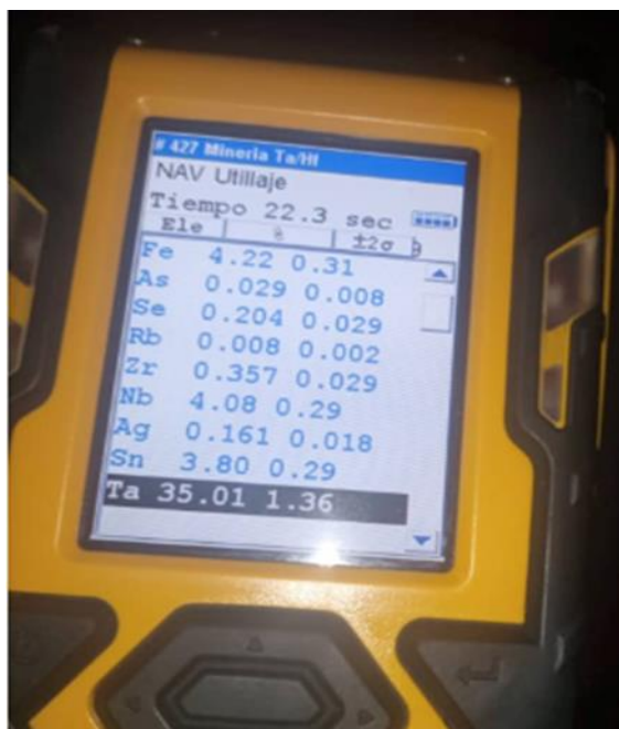
Figura 5.13 Lectura del porcentaje de Ta medido sobre la muestra de C.P Ramón 1.2.
