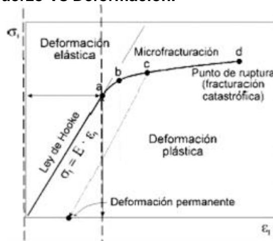
Figura 3: Curva Esfuerzo Vs Deformación.
