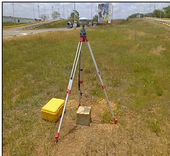
Figura 20 . Monumento de concreto de punto Cantaura2P, perteneciente a la RGM Fuente: autor (2023)
