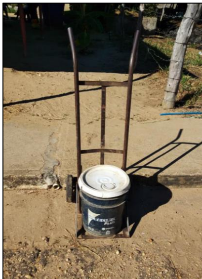
Figura 30. Dispositivo empleado por los habitantes del sector para acarrear agua Fuente: autor (2023)
