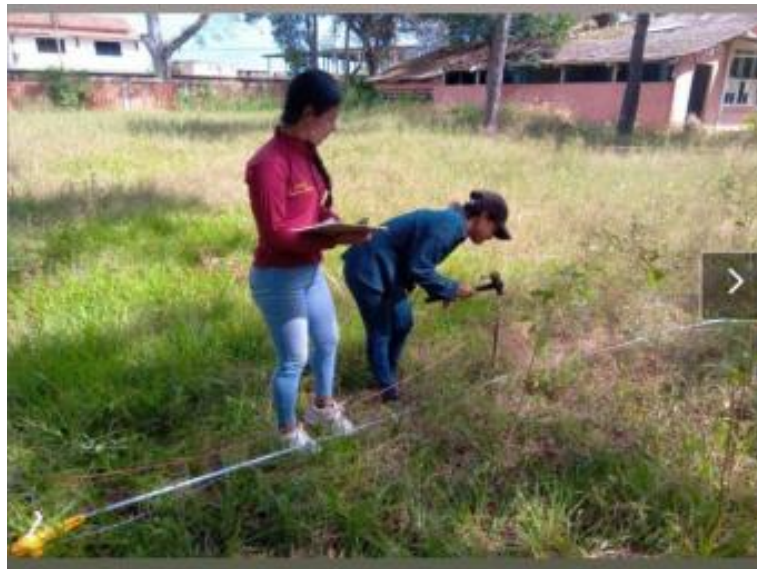
Figura 5.2 Proceso de hincado de electrodos.
