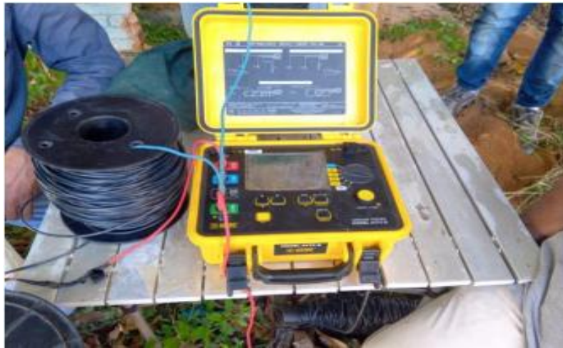
Figura 5.1 Equipo para realizar el Sondeo Eléctrico Vertical.
