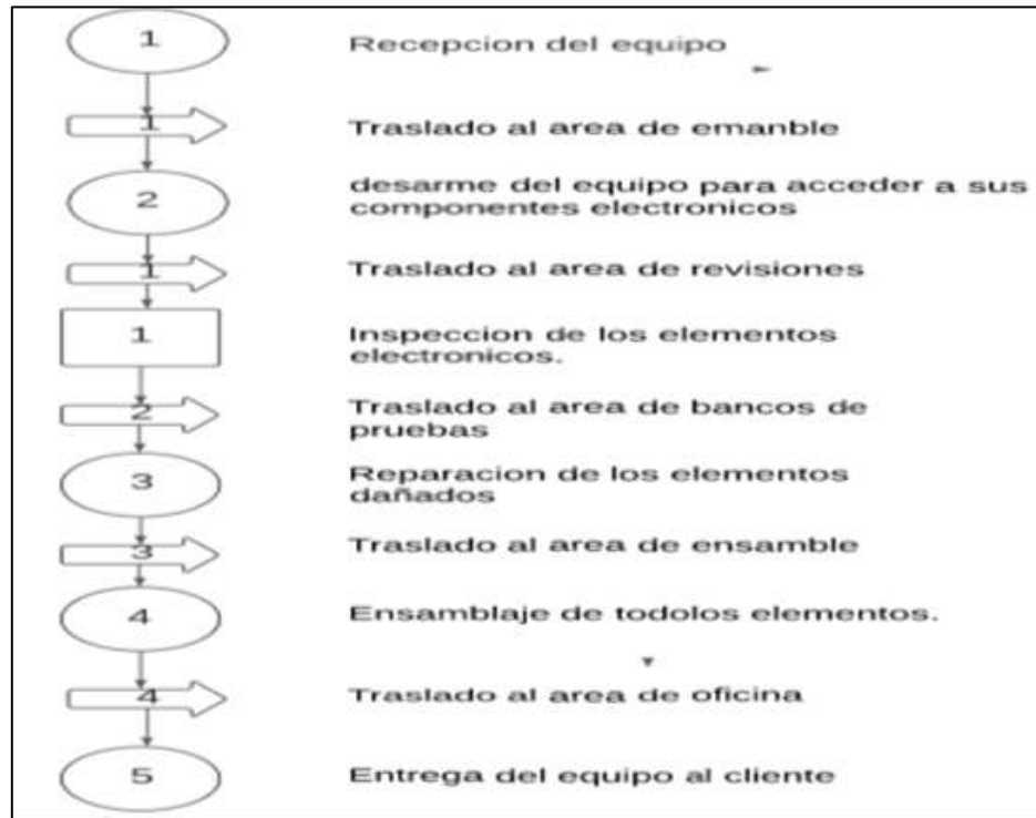
Figura 6.1 Diagrama de flujo del proceso productivo. (Elaboración propia, 2023)
