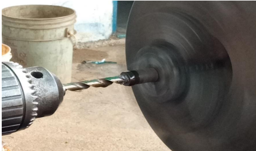
Figura 9. Fabricación de las roscas en las barras. Fuente: autor.
