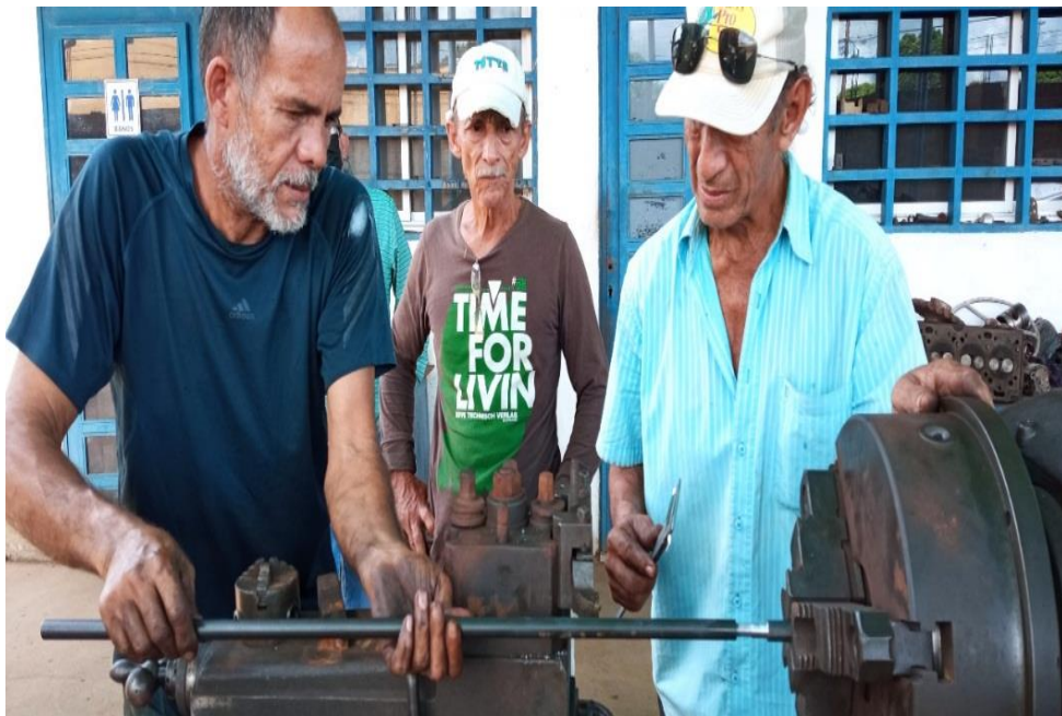
Figura 10. Prueba de ensamblaje de roscas de las barras. Fuente: autor.
