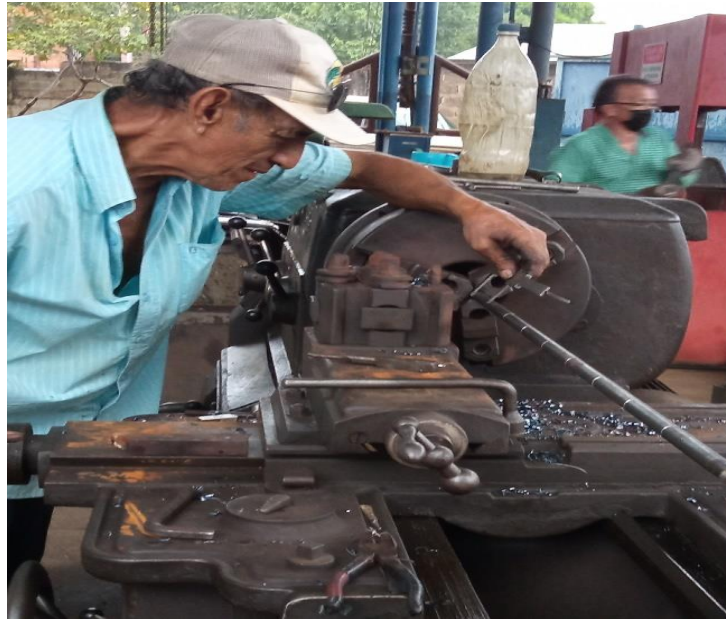
Figura 16. Proceso de medida y marcaje de la barra guía. Fuente: autor.
