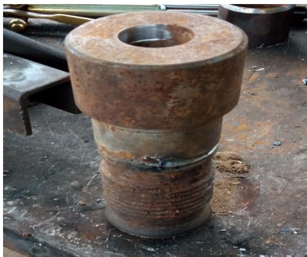
Figura 14. Pesa o martillo correctamente soldada. Fuente: autor.
