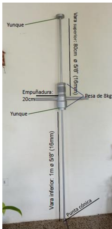
Figura 6. Dimensiones del penetrómetro dinámico de cono.
