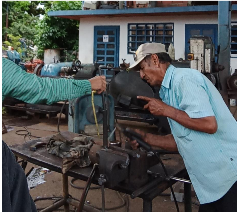
Figura 15. Soldadura de los mangos de agarre para la pesa. Fuente: autor.
