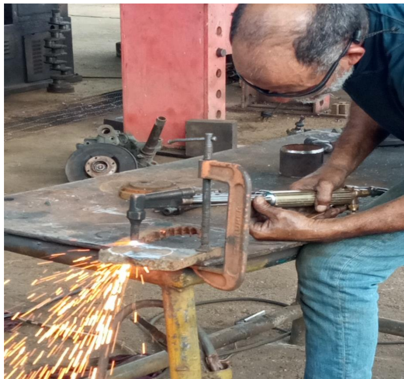
Figura 12. Construcción de arandelas (yunques). Fuente: autor.
