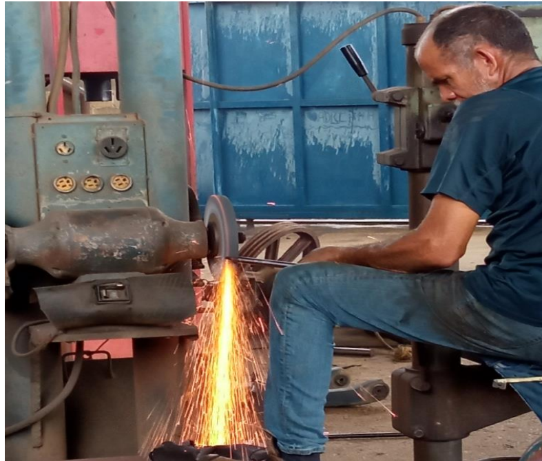
Figura 11. Fabricación de la punta cónica. Fuente: autor.
