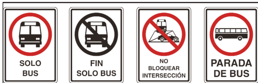
Figura 7. Ejemplo de señales de reglamentación comúnmente utilizada para la regulación del tránsito en los canales preferenciales del transporte público
