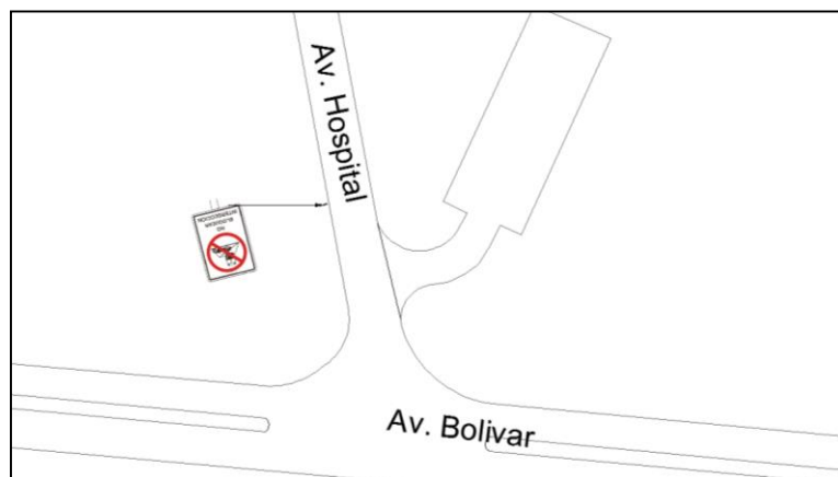
Figura 37. Ubicación de señalización de reglamentación para la regulación del tránsito en intersecciones con preferencia en la Av. Bolívar sobre Av. Hospital
