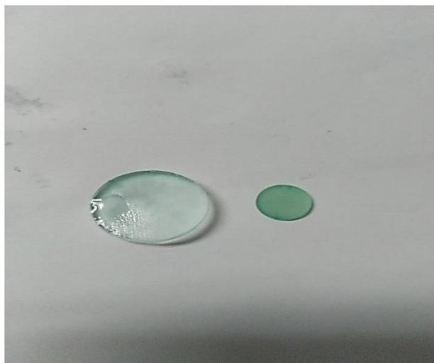
Figura 13. Hidrogel de PAAm/Q hidratado con Paraquat (hidrogel hidratado (izquierda) xerogel (derecha))
