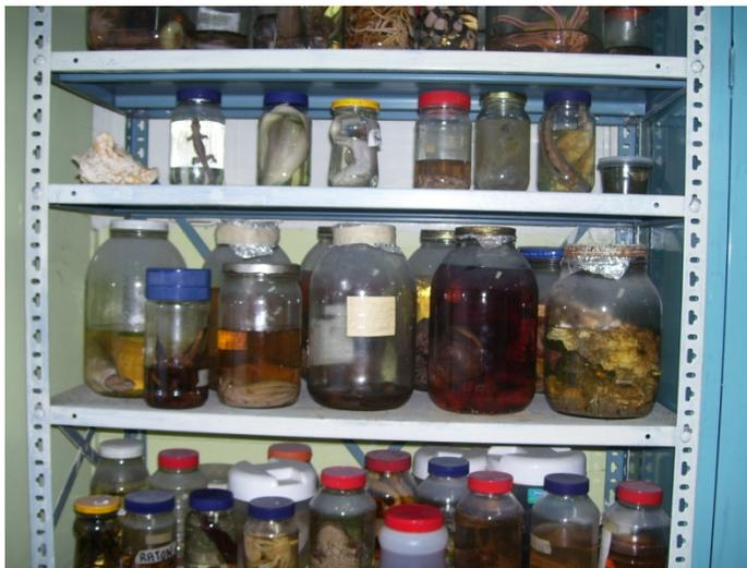
Figura C.25. Almacenamiento inadecuado. Laboratorios.
