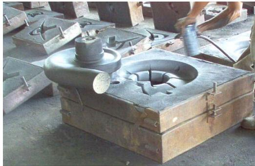
Figura 4.12. Recubrimiento con polvos de sílice y grafito.
