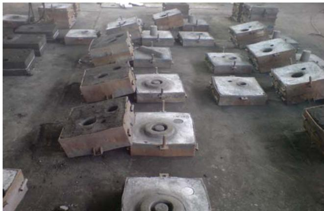
Figura 4.8. Cajas de moldeo preparadas para vaciar.
