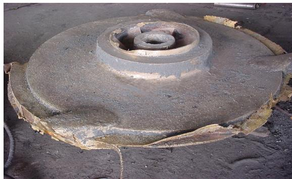
Figura 4.20. Pieza con exceso de colada.
