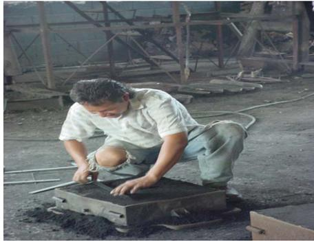
Figura 4.11. Extracción de exceso con barra.
