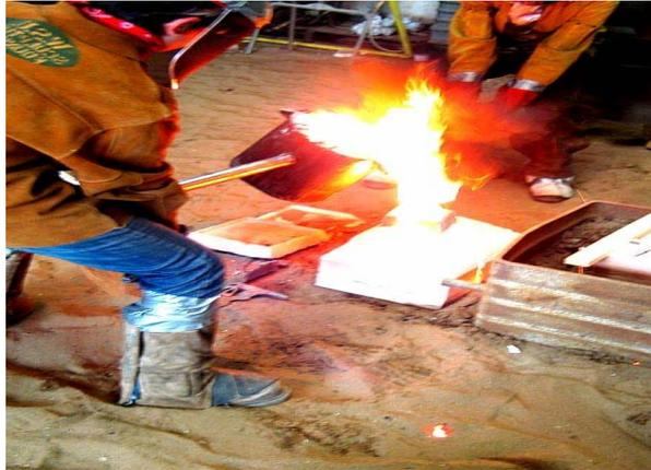
Figura 4.16. Vaciado del metal en el molde.
