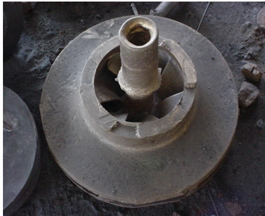
Figura 4.18. Pieza con exceso de colada
