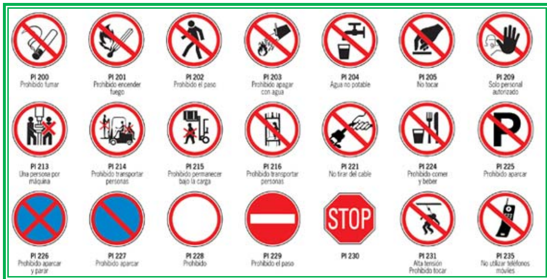
Fig. N° 6.3 Señales de prohibición
