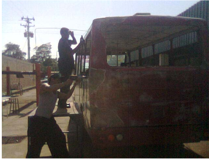
Fig. 4.5 Equipos de protección inadecuados
