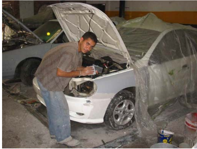
Fig. 4.4 Omisión de los equipos de protección personal
