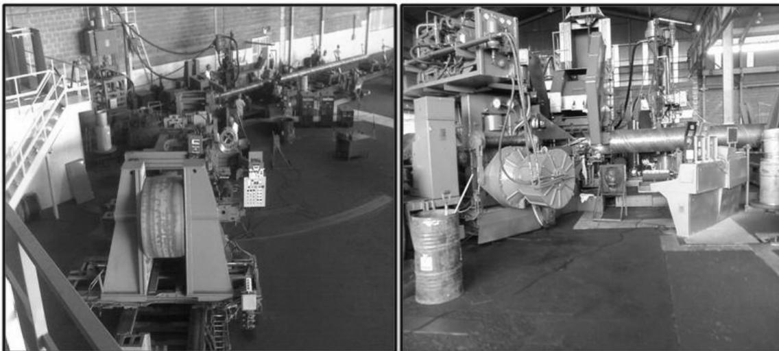
**Figura 2.4-** Máquina conformadora “A” de tubos con soldadura helicoidal.
