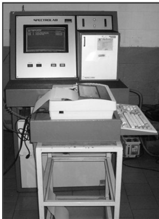
**Figura 2.8-** Analizador químico espectrométrico (SPECTROLAB)
