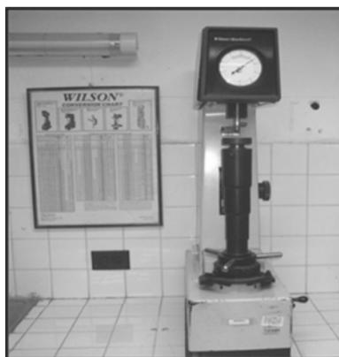
*Figura 2.10- Durómetro Rockwell*
