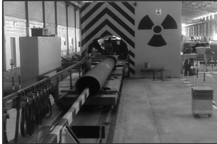
*Figura 2.15- Inspección por fluroscopía*
