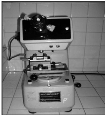
*Figura 2.11- Microdurómetro*
