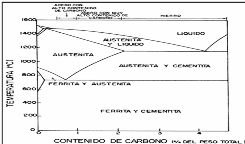
*Figura 2.1- Diagrama de fase del Fe-C.<sup>[7]</sup>*
