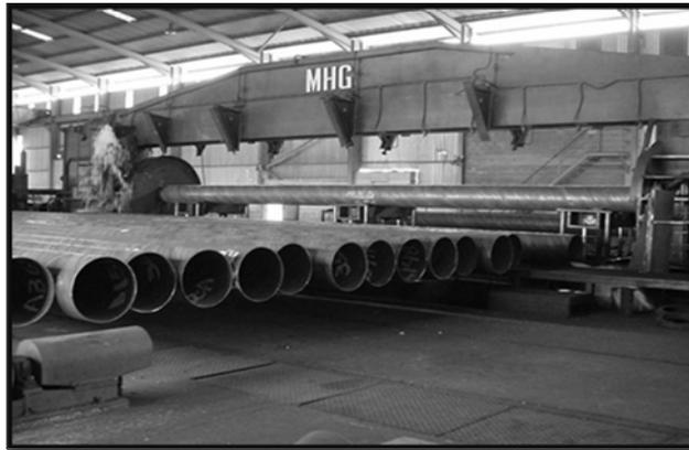
*Figura 2.17- Maquina hidrostática (prensa)*
